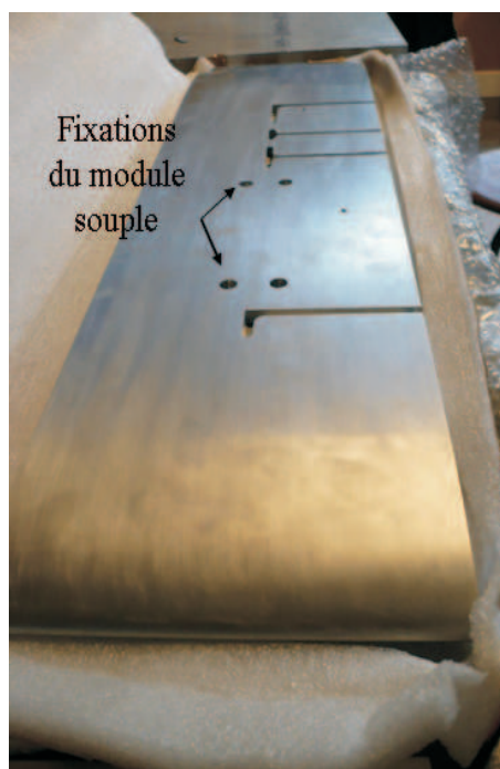
Figure V.7 — Vue de dessous du support rigide
