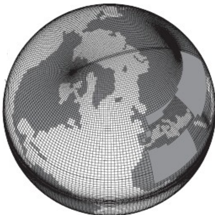
FIG. 2.1 – Grille utilisée dans le modèle OPA sous sa version ORCA2, d'après Marti et al. (2006)
