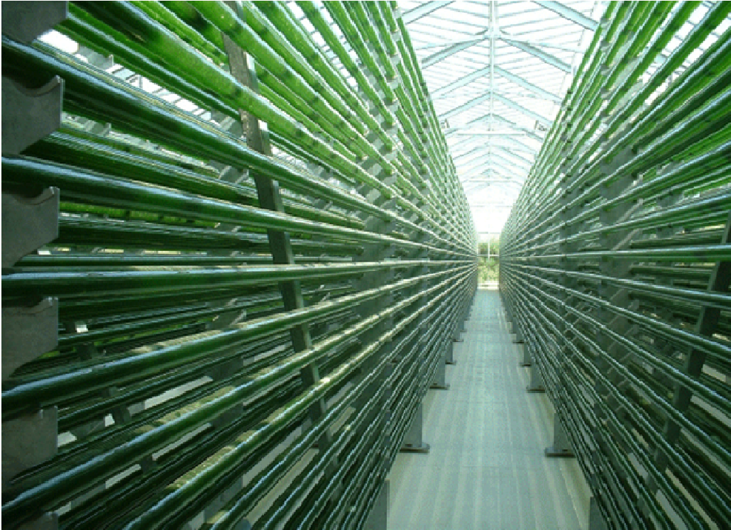
Figure 1.9 : Photobioréacteur tubulaire (D'après : Controlled Environment Agriculture & Energy Working Group of California Polytechnic State University)
