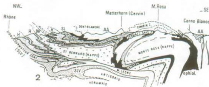
Figure 2.7 : Nappes simploniques. Les nappes du Grand-St-Bernard et du Mont-Rose [tiré de Debelman et Mascle 1994].
