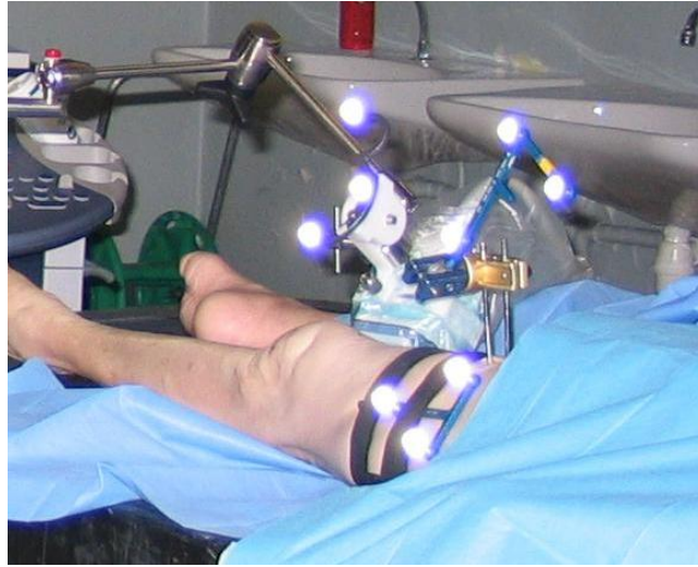
FIG. 5.4 – Expérimentation sur spécimen anatomique. Le corps rigide 3 permet la localisation de la sonde échographique. Le corps rigide F invasif sert de référence « gold standard ». Le corps rigide T non invasif est utilisé à l'initialisation.
