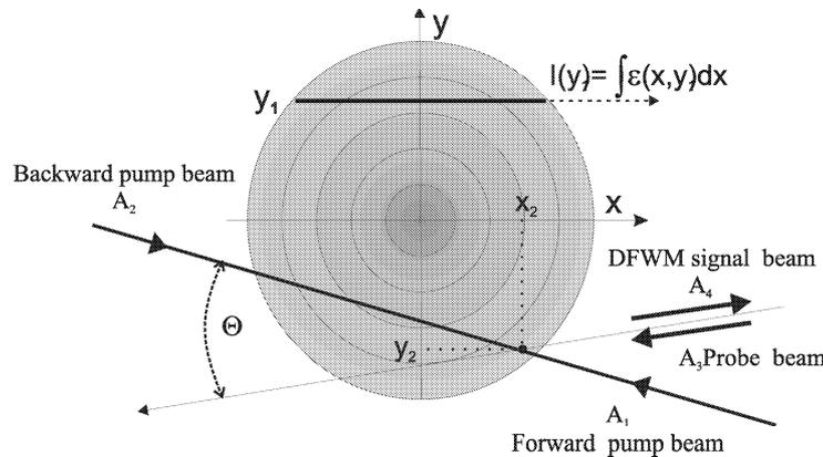
Fig. 4.3 : Principes de la SOE et de la spectroscopie par PC-DFWM
