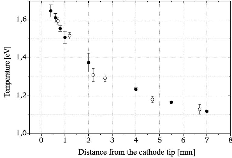
Fig. 4.10 : Distributions axiales de températures obtenues par PC-DFWM (●) et SOE (○).
