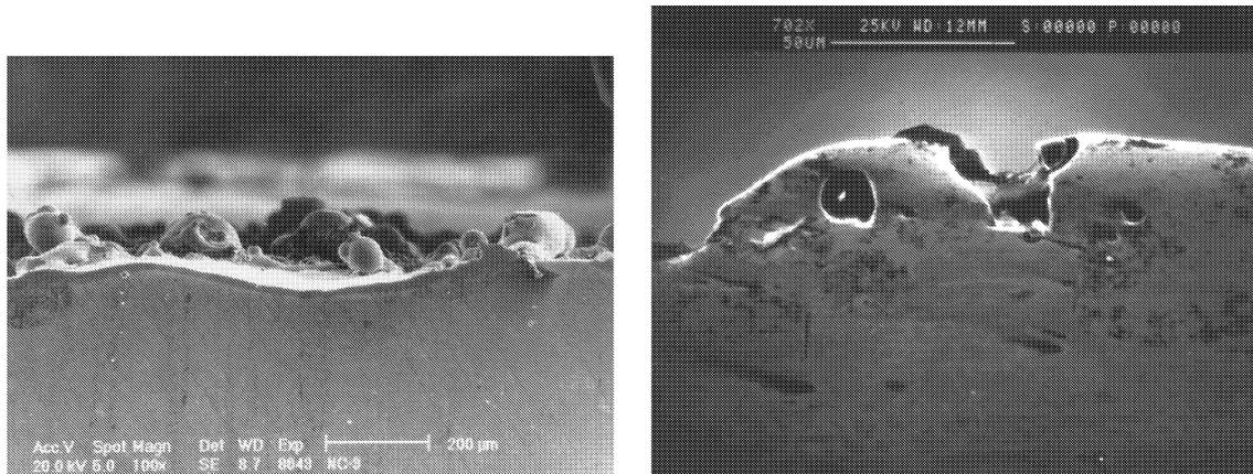
Fig. 2.5 : Aspect d'une électrode traitée par électro-érosion
