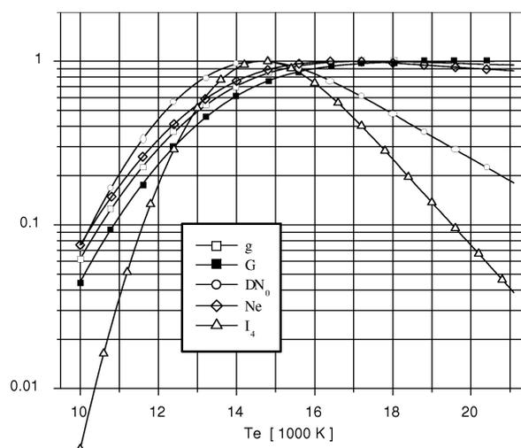
**Fig. 4.5 :** Dépendance en température des paramètres atomiques du plasma
