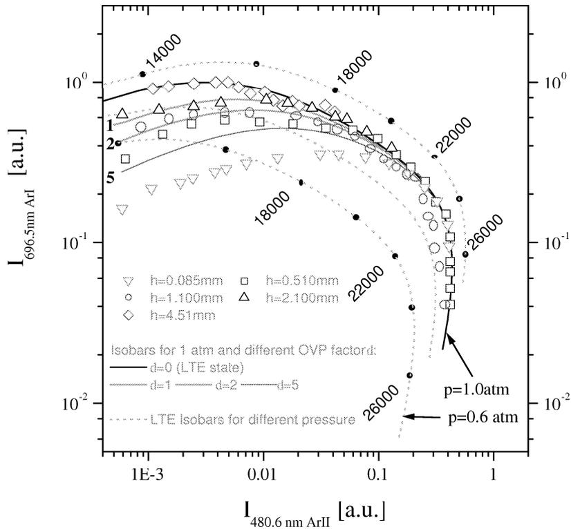
**Fig. 2.1** : Diagramme de Olsen-Richter pour la raie 696.5nm d'ArI et la raie 480.6nm d'ArII en fonction de la distance  $h$  à la pointe cathodique
