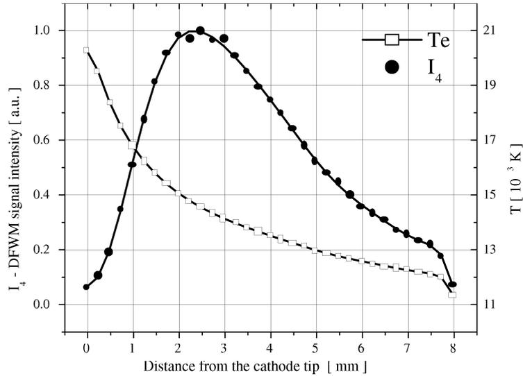
**Fig. 4.6 :** Distributions axiales du signal  $I_4$  de PC-DFWM et de la température électronique  $T_e$  [Plasma d'argon en ETL à pression atmosphérique -  $I_{arc}=100\text{A}$  ;  $D_g=4\text{l/mn}$ ]
