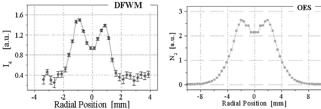
Fig. 4.9 : Distributions radiales de  $\Delta N_0$  et  $N_2$  obtenues par PC-DFWM et SOE.
