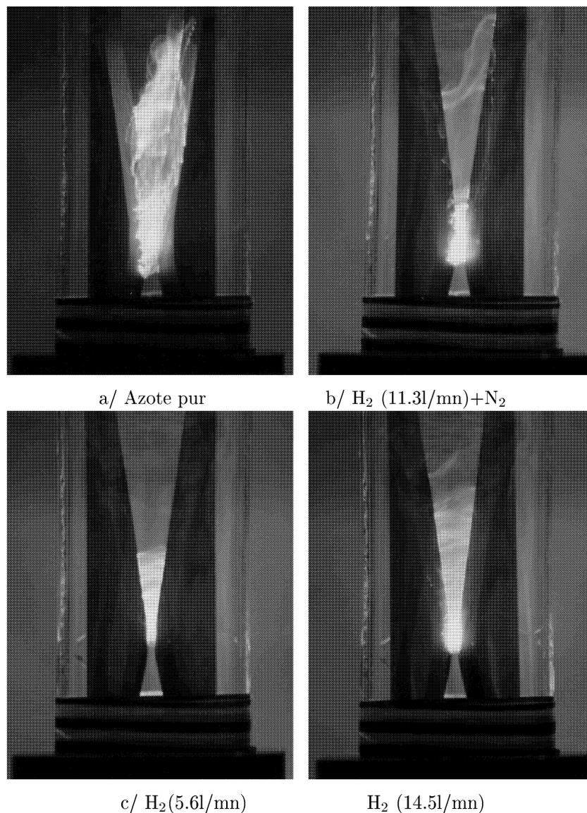
**Fig. 3.2** : Aspect d'une décharge glissante dans l'hydrogène -  $d_{elec}=1.5\text{mm}$
