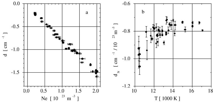
**Fig. 4.12** : Déplacement Stark  $d$  en fonction de la densité électronique  $N_e$  (a) et déplacement Stark  $d_n$  normalisés à  $N_e^0 = 10^{23} \text{m}^{-3}$  en fonction de la température  $T_e$  (b)
