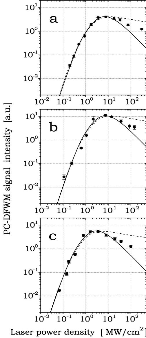
**Fig. 4.4** : Signal de PC-DFWM en fonction de la densité de puissance laser sur le faisceau direct
