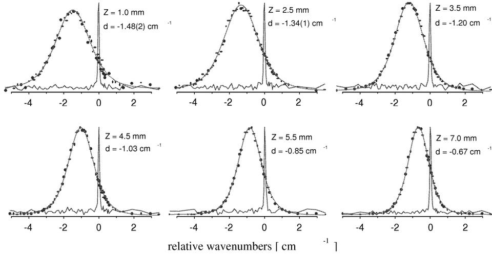
**Fig. 4.11** : Profils spectraux du signal de PC-DFWM enregistrés à basse intensité laser sur l'axe de la colonne, mesurés à différentes distances  $h$  de la pointe cathodique [ • Points expérimentaux et ajustage numérique (Cf texte) ; ligne : Signal de la cathode creuse]
