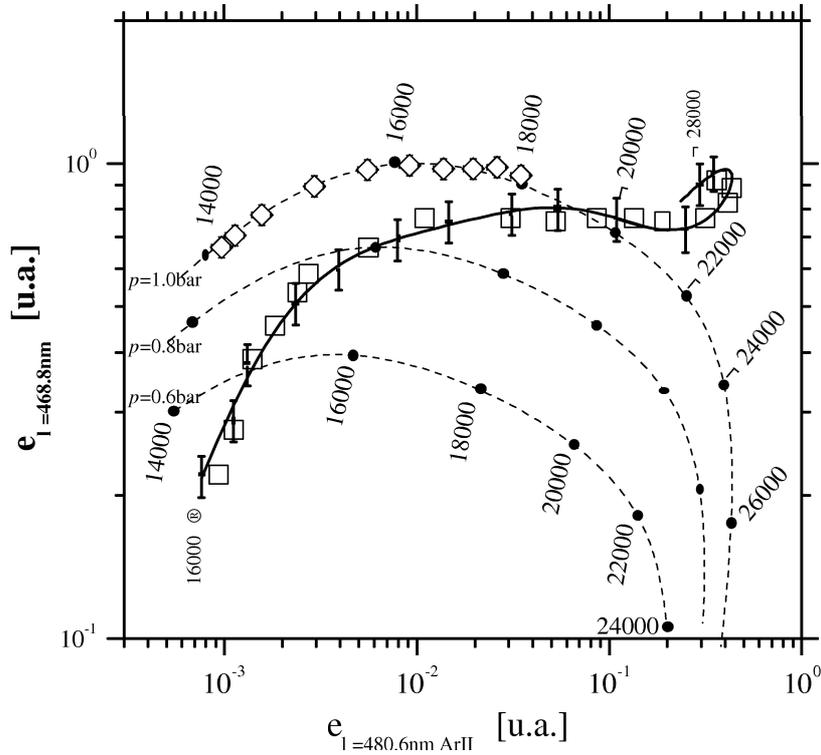
**Fig. 4.1 :** Diagramme de Olsen-Richter pour l'émission continue à  $\lambda=468.8\text{nm}$  et la raie  $480.6\text{nm}$  d'ArII en fonction de la distance  $h$  à la pointe cathodique
