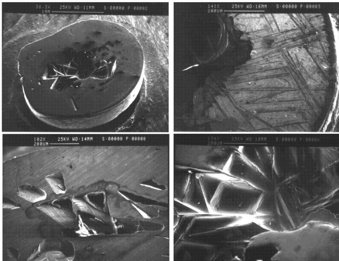
Fig. 2.6 : Aspect d'un résidu d'électro-érosion
