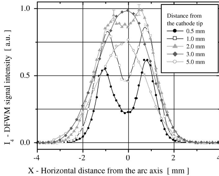
**Fig. 4.7** : Distributions radiales du signal  $I_4$  de PC-DFWM à différentes distances de la cathode [Plasma d'argon en ETL à pression atmosphérique -  $I_{arc}=100A$  ;  $D_g=4l/mn$ ]
