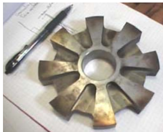
Figures 17. Photos des rotor réalisés : (a) massif, (b) feuilleté
