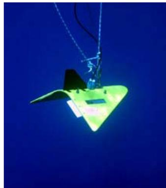
Figure 2-15 : Système de suivi actif utilisé lors des déplacements de dorades coryphènes. Il se compose de quatre hydrophones fixés sur une paravane tractée par le bateau et d'un récepteur (Vemco VR28). Les localisations du bateau sont mesurées à l'aide d'un GPS relié au récepteur. Un ordinateur enregistre les données en temps réel (source : C. Girard).
