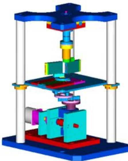
*Figure 13 : Fichier CAO du troisième prototype de l'essai de flexion alternée.*
