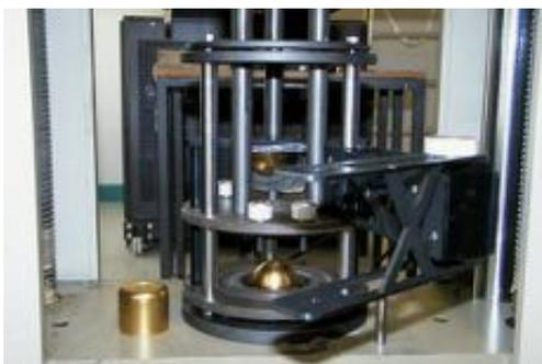
Photo 6 : Module d'emboutissage livré à l'université de METZ
