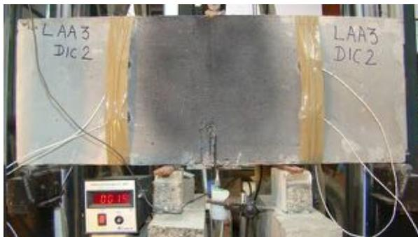
Photo 16 : Poutre en béton pré fissurée soumise à flexion 3 points
