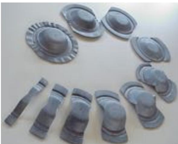
Photo 4 : Ensemble de flans nécessaires pour l'obtention d'une CLF
