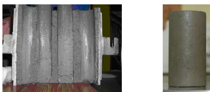
FIG. 80: Moule standard CBR et échantillon testé (35 mm × 70 mm).
