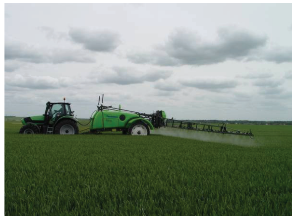
Fig. I.3 : Les pulvérisateurs Automoteur Laser 4240 (à gauche) et traîné Fortis Evolution (à droite) par Tecnomat proposent des rampes jusqu'à 42m et peuvent contenir plus de 4 000 litres de bouillie (eau+produit phytosanitaire) (Tecnomat, 2009).
