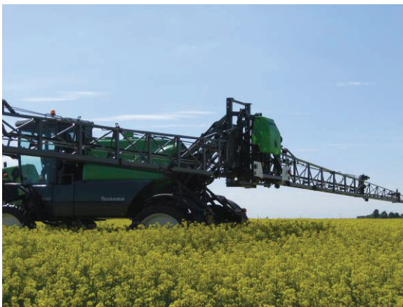
Fig. I.3 : Les pulvérisateurs Automoteur Laser 4240 (à gauche) et traîné Fortis Evolution (à droite) par Tecnomat proposent des rampes jusqu'à 42m et peuvent contenir plus de 4 000 litres de bouillie (eau+produit phytosanitaire) (Tecnomat, 2009).
