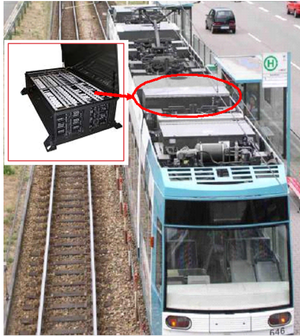
Fig. 1.15: Système de stockage supercapacitif de MITRAC
