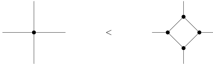
FIG. 1.3 – Si G+H est planaire, dans le cas arête-disjoints, on peut remplacer les sommets de degré 4 par des sommets de degré 3, car s'il existe une solution, il existe une solution pour laquelle les chemins ne se croisent pas.
