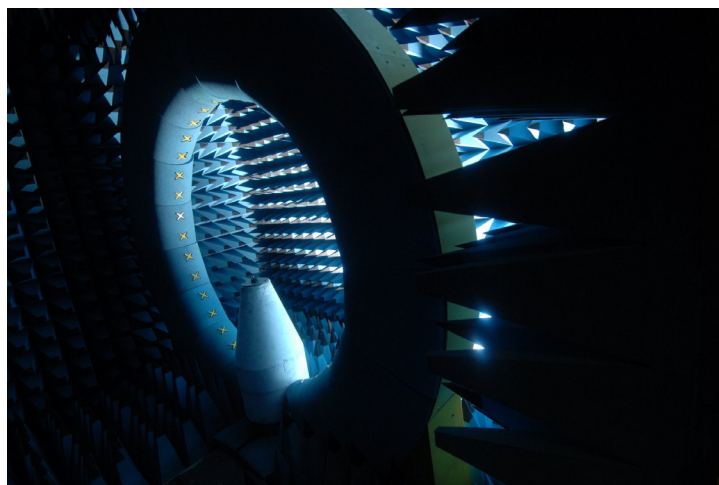
FIGURE 1.4 – Base champ proche de l'IETR (Satimo Stargate 32)
