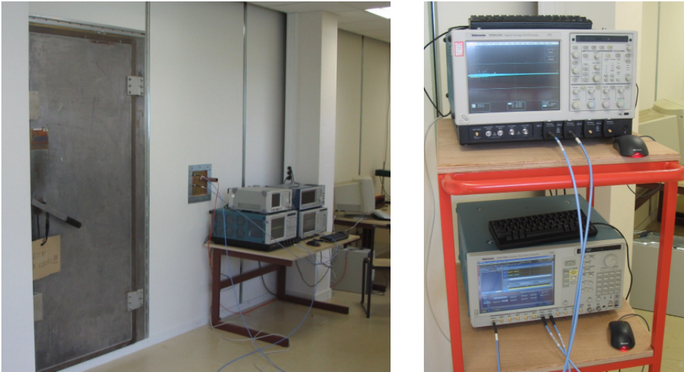
FIGURE 3.5 – Vue extérieure de la CRBM et instrumentation
