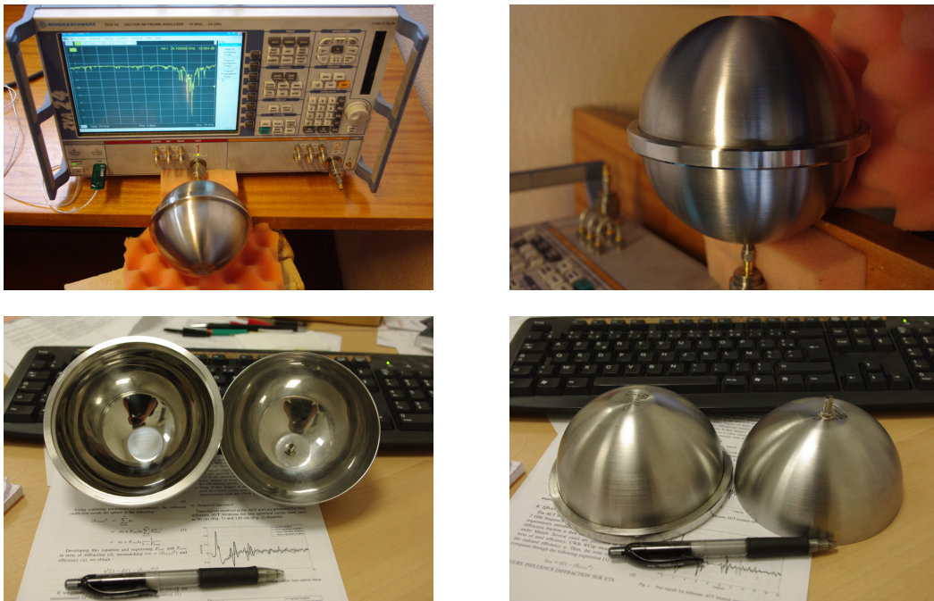
FIGURE 2.56 – l'ULB Wheeler Cap de 6cm de rayon
