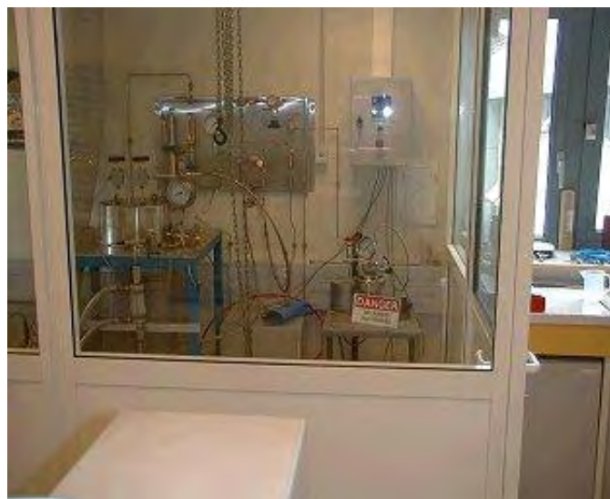
Figure 16 : Confinement de la boucle supercritique dans son bocal de protection (on peut distinguer à gauche l'autoclave de 19 litres et à droite, celui d'1 litre)
