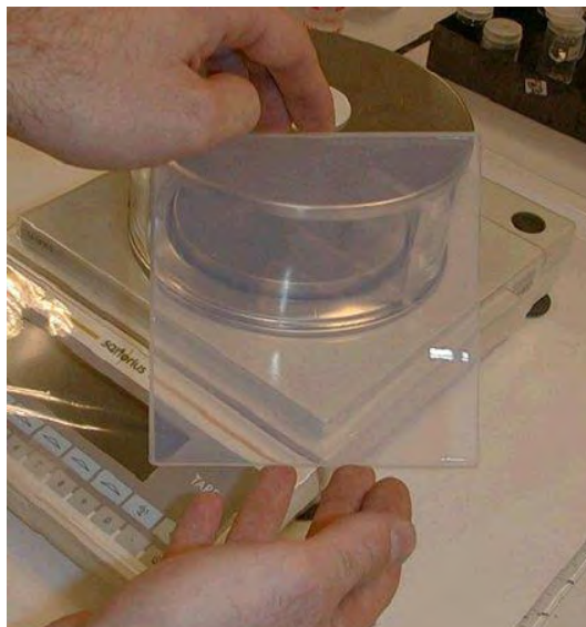
Figure 19 : Echantillon typiquement obtenu par séchage au CO 2 supercritique direct (0.15 g/cm 3 , 0.018 W/m.K, %TR ~ 90%)
