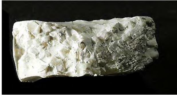
Figure 118 : Vue d'un aérogel composite à base de polyuréthane et de granules d'isogel
