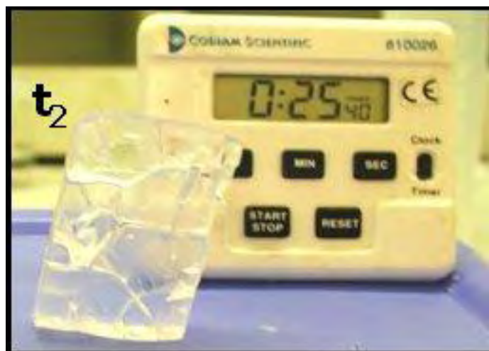
Figure 12 : Morcellement d'un gel de silice en phase d'évaporation (ici, gel imprégné d'ETAC)
