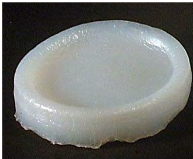
Figure 81 : Aérogel d'acétate de cellulose ( \rho \sim 0.2 \text{ g/cm}^3 )
