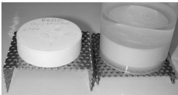
Figure 66 : Obtention d'un aérogel de polyuréthane (à gauche) par séchage sous CO 2 supercritique du gel correspondant (à droite)
