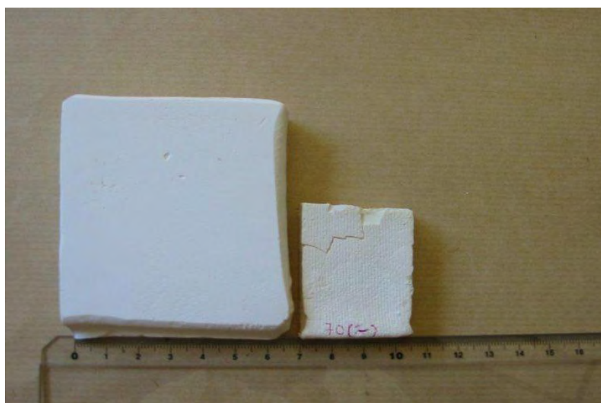
Figure 76 : Comparaison entre un cryogel (à gauche) et un xérogel (à droite) de polyuréthane (gels respectivement lavés au cyclohexane et au Forane)
