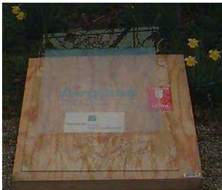
Figure 29 : Plaque d'aérogel de silice ( 60 \times 60 \times 2 \text{ cm}^3 ) élaborée par AIRGLASS AB ( 0.15 \text{ g/cm}^3 , 0.016 \text{ W/m.K} et %TR > 90%)
