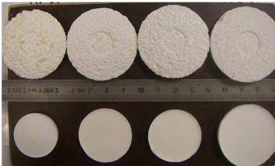
Figure 119 : Aérögels de polyuréthane (en bas) et leurs composites à base de granules d'isogel (en haut)
