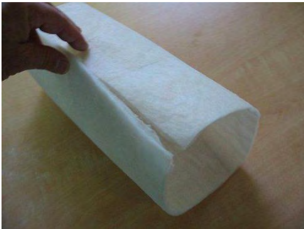
Figure 56 : Blanket à base de Quartzel® développé par PCAS selon le protocole mis au point au CEP
