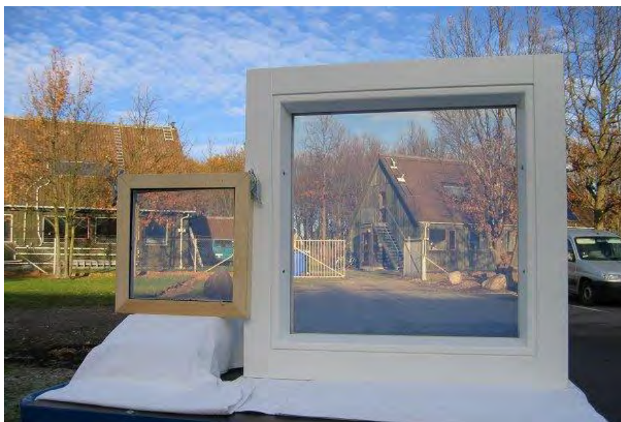
Figure 30 : Prototypes de vitrage (à gauche) et de fenêtre aérogels (à droite) réalisés par DTU dans le cadre du projet HILIT+
