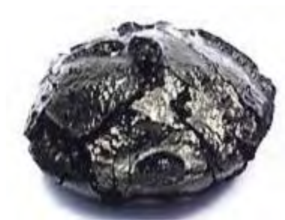
Figure 93 : Aérogel de carbone obtenu par pyrolyse d'un aérogel d'acétate de cellulose (se présentant initialement sous la forme d'un cylindre plat)
