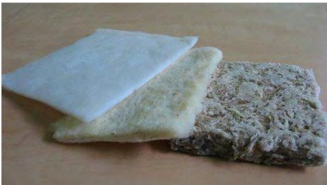
Figure 57 : De gauche à droite, blanket de référence (à base de Quartzel®), blankets à base de laine de mouton et de tissus recyclés
