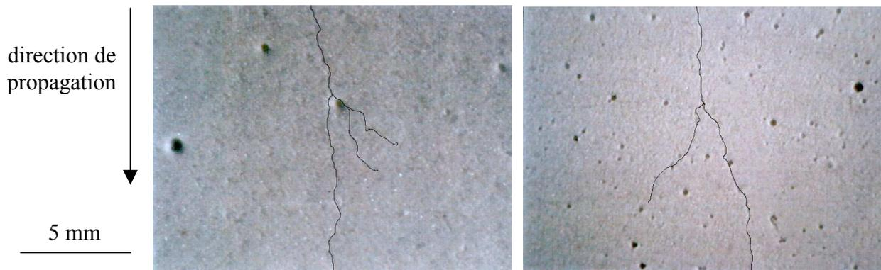
*Figure 4.13 : Ramification de la fissure (les ramifications sont surlignées pour les faire apparaître plus clairement).*
