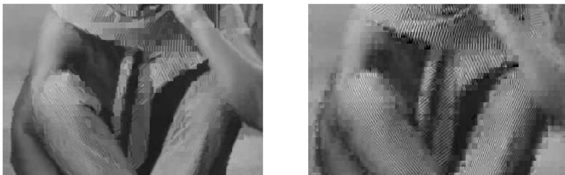
FIG. 4.11 – Détail de prédiction intra 8 × 8 de la norme à gauche ; prédiction parcimonieuse appliquée à des blocs 8 × 8 à droite
