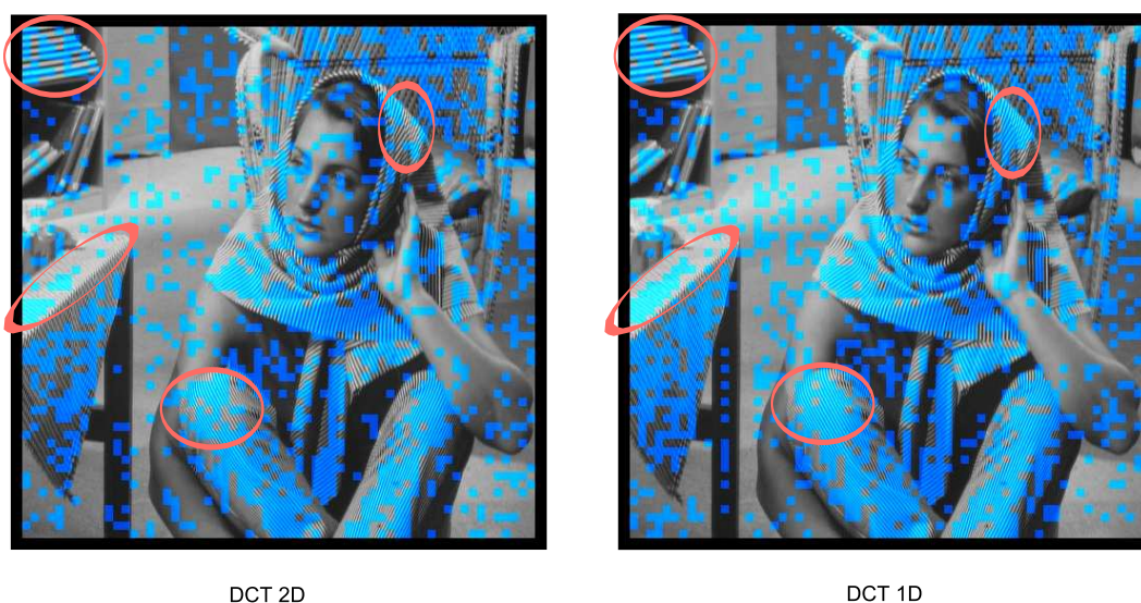
FIG. 6.18 – Visualisation, sur l'image source, des blocs de prédiction retenus, selon un critère SSE, lorsqu'ils ont été prédits par la prédiction parcimonieuse. A gauche, avec le dictionnaire 2D ; à droite, avec les atomes 1D
