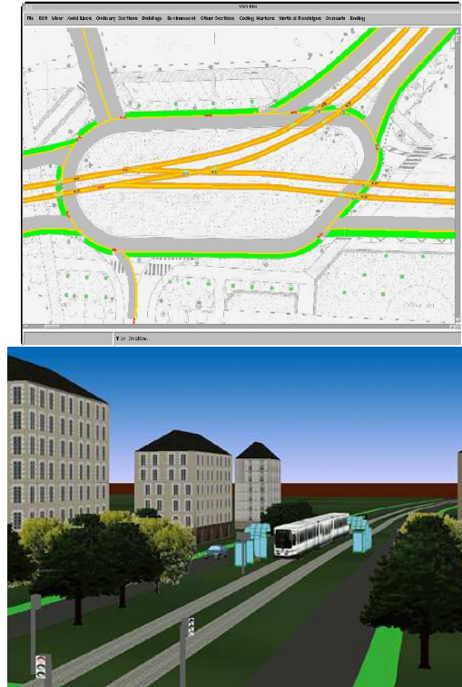
FIG. 2.23 – Intégration du tramway dans le carrefour de la Croix-Bonneau à Nantes
