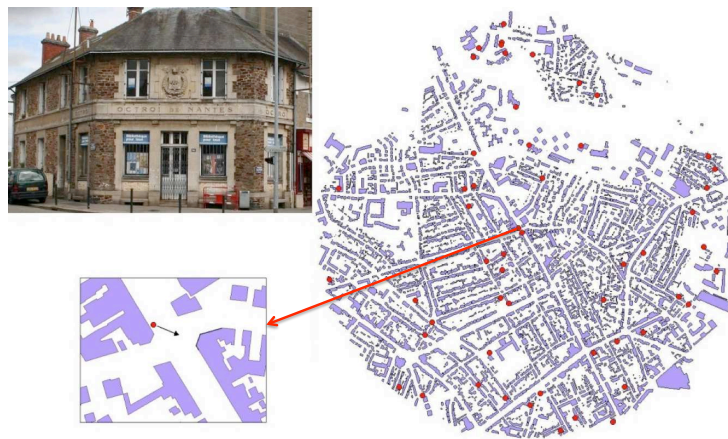
FIG. 3.5 – Premier résultat de calcul de poses possibles sur une paire de façades
