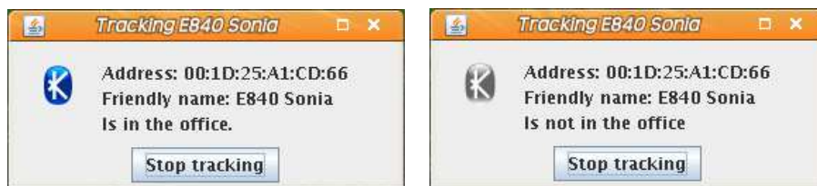
FIG. 4.22 – Boîte de dialogue de suivi d’un périphérique bluetooth, dans le cas où le périphérique est présent (gauche) et absent (droite).
