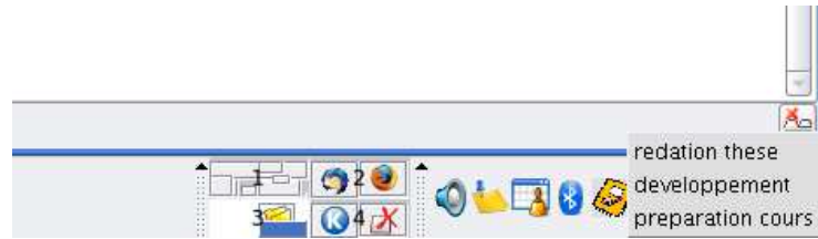
FIG. 4.19 – L'icône taskSwitcher est présent dans la zone de notification et permet, d'un clic droit, de changer la tâche courante.
