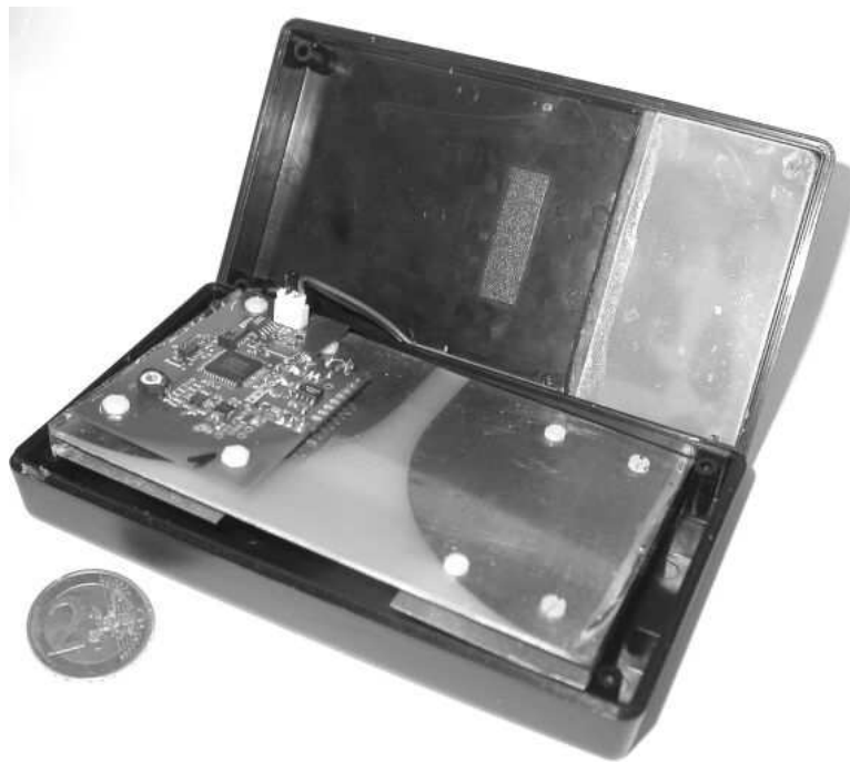
Figure 6 - 4 : Prototype complet d'émetteur ULB réalisé au LETI à base de composants discrets fonctionnant dans la bande-basse [0.5:1.1]GHz
