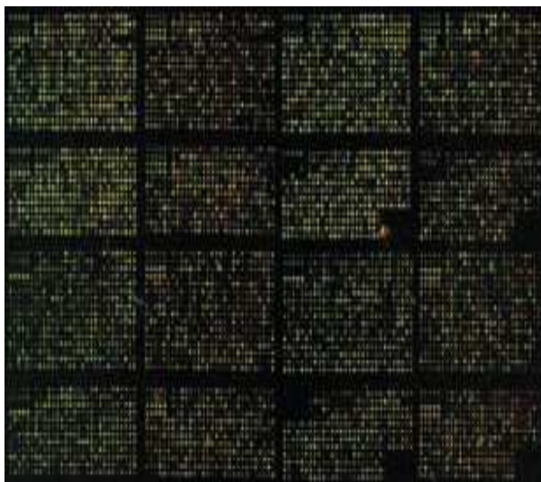
FIG. 1.5 – Une puce constituée de 16 blocs ( 4 \times 4 ) illustrant l'image de la totalité du transcriptome de la levure (6300 gènes)(Soularue et Gidrol [92]).
