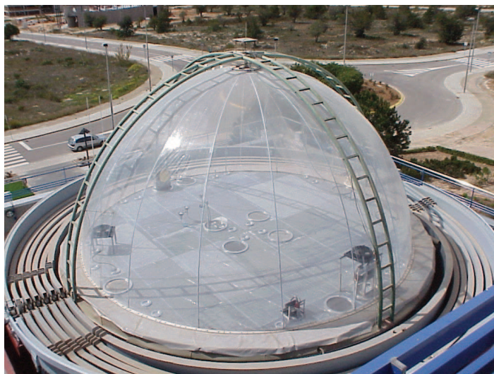
Figure 2.3. Photographie de l'une des deux chambres de simulation atmosphérique à irradiation naturelle Euphore (Valence, Espagne).
