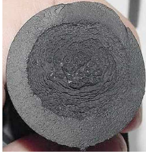
FIG. 5.4 – Faciès de rupture caractéristique d'un amorçage à cœur sous l'insert métallique.
