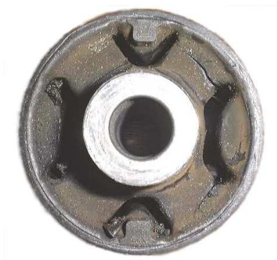
FIG. 4 – Fissures dans une articulation de triangle soumise à un chargement complexe.
