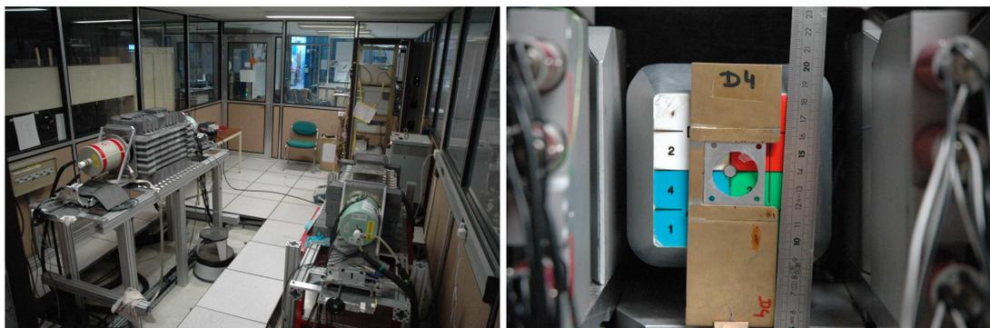
FIG. 2.15: (Gauche) Photographie des deux bancs de mesure du dispositif de comptage hors ligne. (Droite) Photographie de l'intérieur du banc de mesure B2 prise à partir de la position du détecteur planaire qui montre le porte cible et les enceintes anti-Compton BGO passives sur les parois de l'enceinte de Pb.
