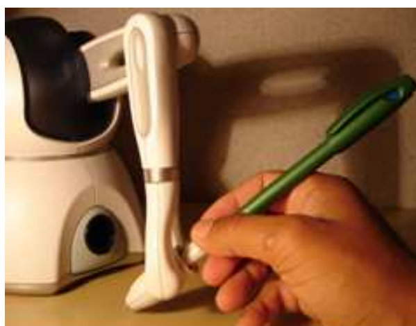
FIGURE 6.4 – Modification de la prise en main du stylo par le changement du corps du stylo. D'après Bluteau et al. (2008).
