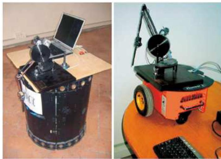
FIGURE 2.14 – Exemple de robots porteurs. Un dispositif manipulable (PHANToM Premium 1.5) est posé sur le transporteur d’après Barbagli (2006).
