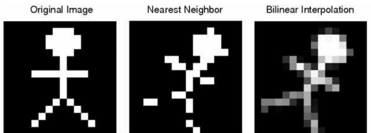
FIGURE 4.1 – Influence de deux types d'interpolations couramment utilisés en vision sur une image bidimensionnelle simple inclinée. (Gauche) Modèle original. (Centre) Reconstruction de l'image en utilisant un algorithme « Nearest-Neighbor » qui assigne la valeur de couleur du pixel courant à celle du plus proche voisin. (Droite) Reconstruction de l'image en utilisant un algorithme d'interpolation bilinéaire qui, pour chaque pixel créé une moyenne pondérée des quatre pixels les plus proches.
