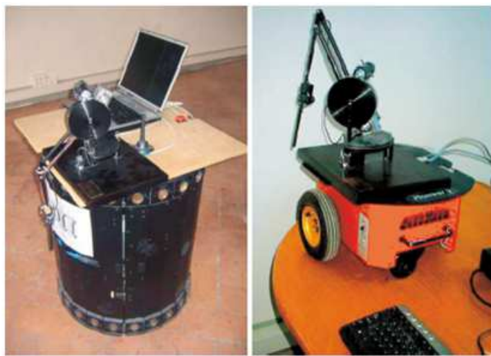
FIGURE 2.14 – Exemple de robots porteurs. Un dispositif manipulable (PHANToM Premium 1.5) est posé sur le transporteur d’après Barbagli (2006).
