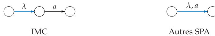
FIG. 2.3 – La représentation des transitions interactives et markoviennes dans IMC et les SPA
