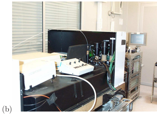
FIG. 2.5 – (a) Le diagramme et (b) une photographie du lidar ALTO. D'après Ancellet and Ravetta (1998) et www.aero.jussieu.fr/themes/PCT/alto.html , respectivement.
