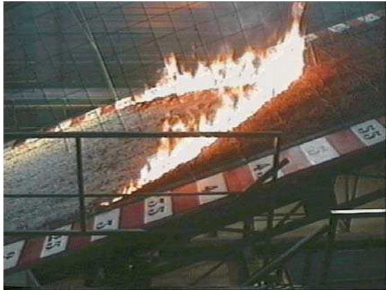
Figure 6.13 : Vue latérale de la propagation d'un front de flammes elliptique sur un plan incliné ; laboratoire de l'INRA d'Avignon
