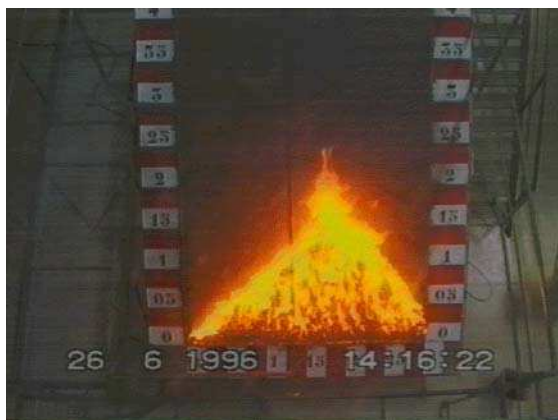
Figure 6.15 : Enregistrement de la progression du front de flammes ; laboratoire de l'INRA d'Avignon
