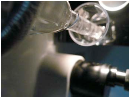
Figure 13 : vue du Compteur Coulter « aspirant » l'échantillon en arrière plan.
