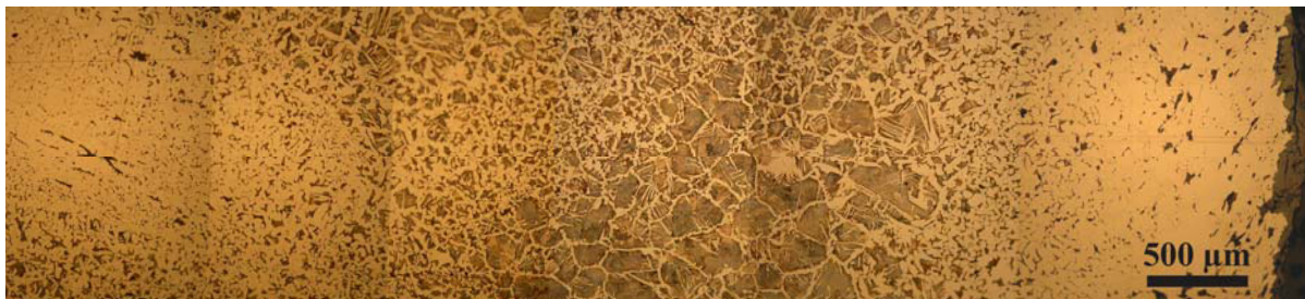
Figure B.1 – Mise en évidence des hétérogénéités des matériaux ferreux anciens (attaque Nital). (Haut) taille des grains (Dillmann, 2006). (Bas) microteneur en carbone (L'Héritier, 2007)
