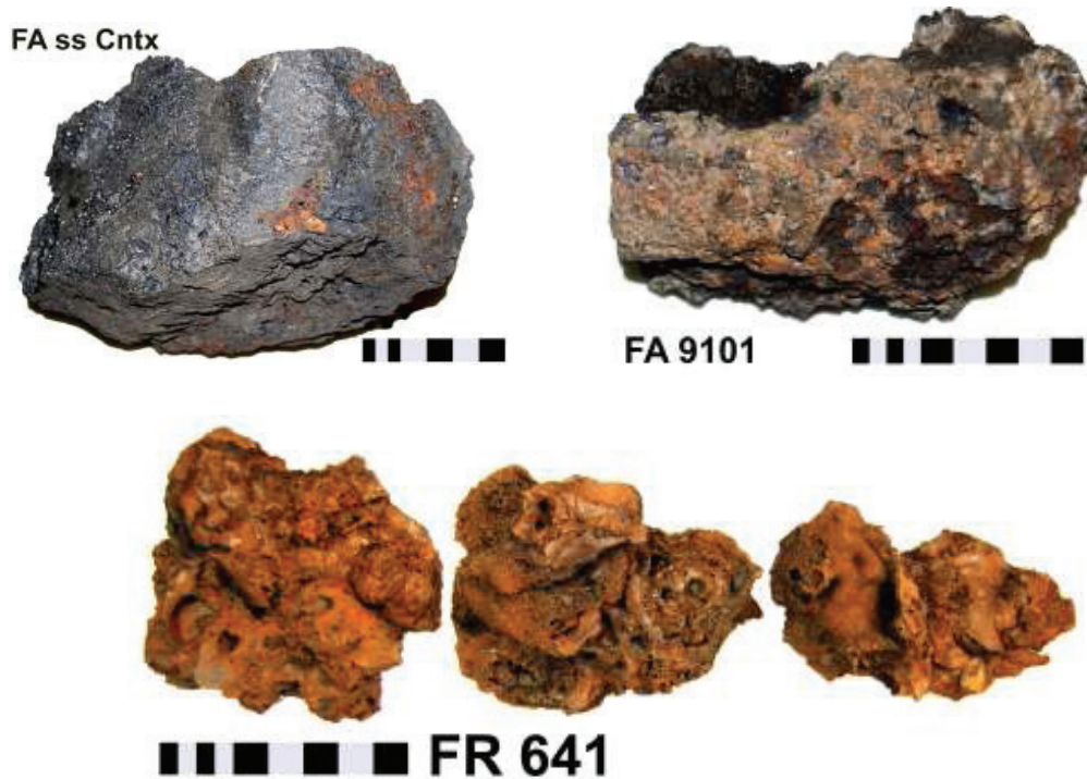
Figure III.23 – Différents types de scories mises au jour sur les Farga Areny et Farga Rossell et analysées dans ce travail : (FA ss Cntx) : fragment de la sole du bas foyer, scorie compacte ; (FA9101) : partie d'une coulée du chio ; (FR641) : scories coulées très poreuses (clichés O.Codina)
