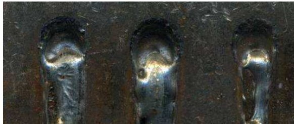
Figure 42 : Observation de la fin des cordons (vue de dessus) après un arrêt brutal de la soudure pour déterminer la déformation du bain
