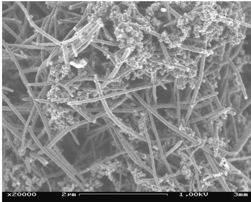
Figure 21 : Observation MEB d'un échantillon collecté sur les électrodes (échantillon 221, hélium, nickel, zone d'aspiration « basse »)
