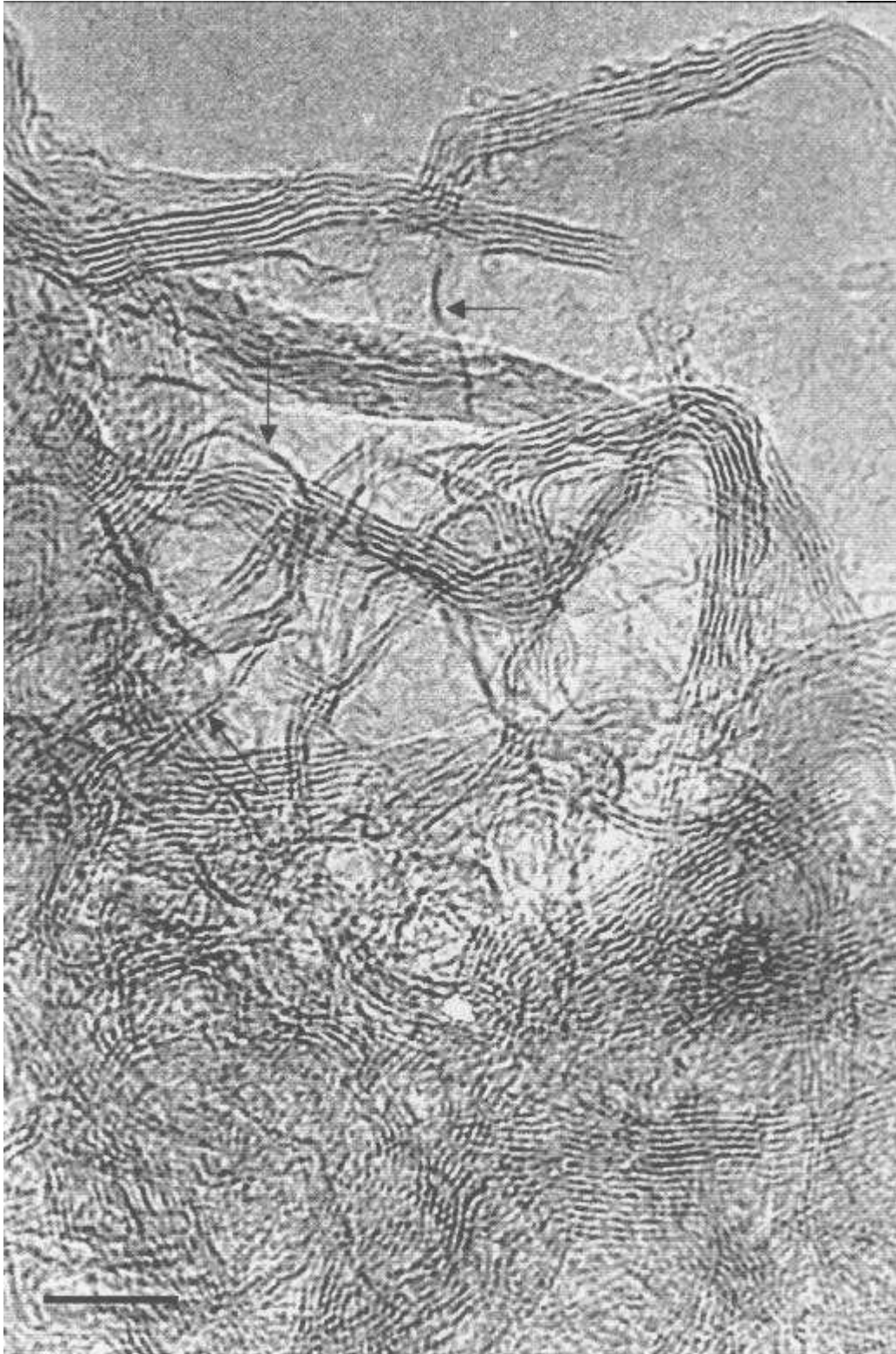
Figure 10 : Noir plasma montrant une croissance en nombre réduit de couches (TEM, franges de réseau 002, la barre fait 5 nm)
