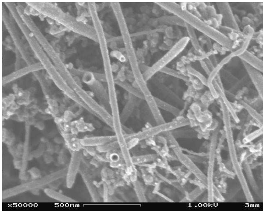
Figure 22 : Observation MEB d'un échantillon collecté sur les électrodes (échantillon 221, hélium, nickel, zone d'aspiration « basse »)
