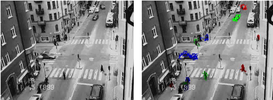
FIG. 4.12: Résultats de la détection de clusters en mouvement sur l'image 109 de la séquence trafic.
