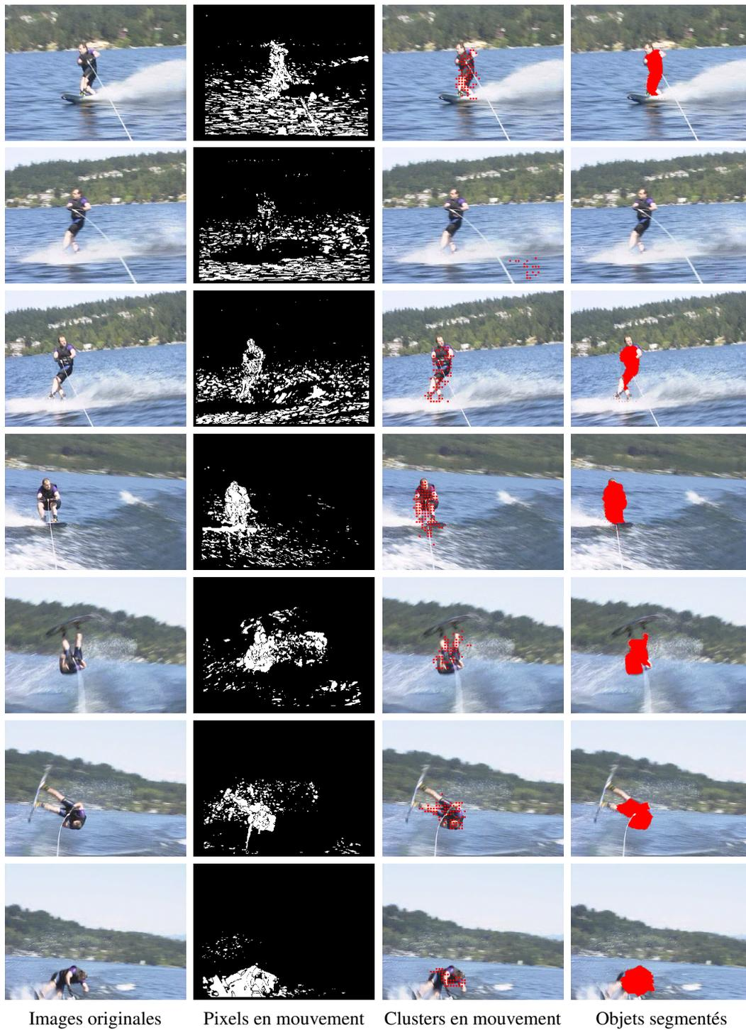
FIG. 5.1: Résultats de la détection sur la séquence de ski nautique pour les images 74, 124, 144, 214, 232, 236 et 242
