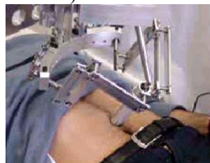
Figure 1.12 Photographie du poignet robotique de [Najafi, 04]
