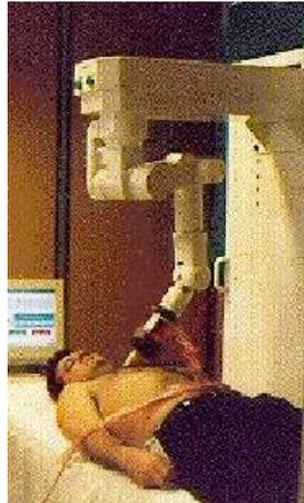
*Figure 1.18 Robot porte-sonde « Hippocrate »*
