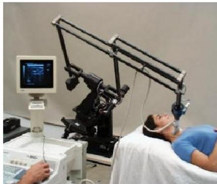
Figure 1.13 Photographie du robot parallélogramme de [Salcudean, 99a]
