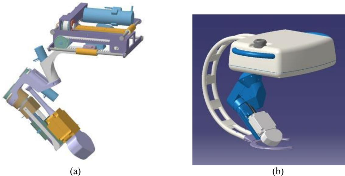
Figure 5.18 Structure mécanique du robot Otelo2, (a) parties intérieures et (b) forme finale avec capots et pieds support
