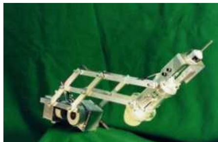
Figure 1.19 Robot porte-transducteur pour ultrasons focalisés à haute intensité. Photo présentée sur le site [Imperial, www]
