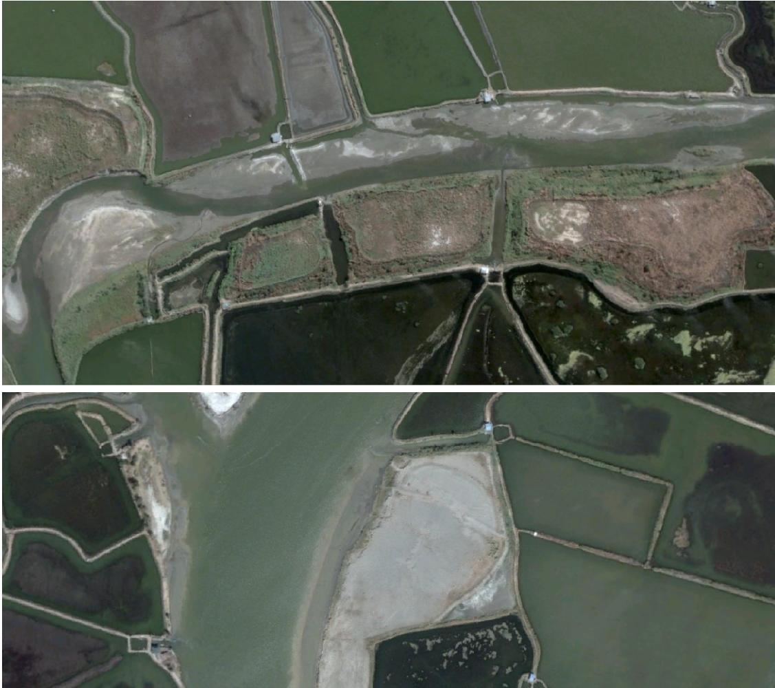
Figure 8-53 - Produits du Pinatubo devenus ressources (haut: dépôts de lahars comblant des canaux ; bas: étang condamné car comblé par des dépôts de lahars à présent en cours de dragage)
