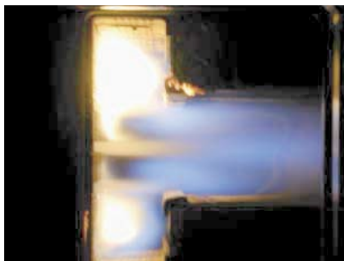
FIGURE 2.12: Photo d'une chambre TVC en fonctionnement [96]. Conditions de l'essai : T_3 = 533 K, P_3 = 3.45 bar, \phi = 0.53
