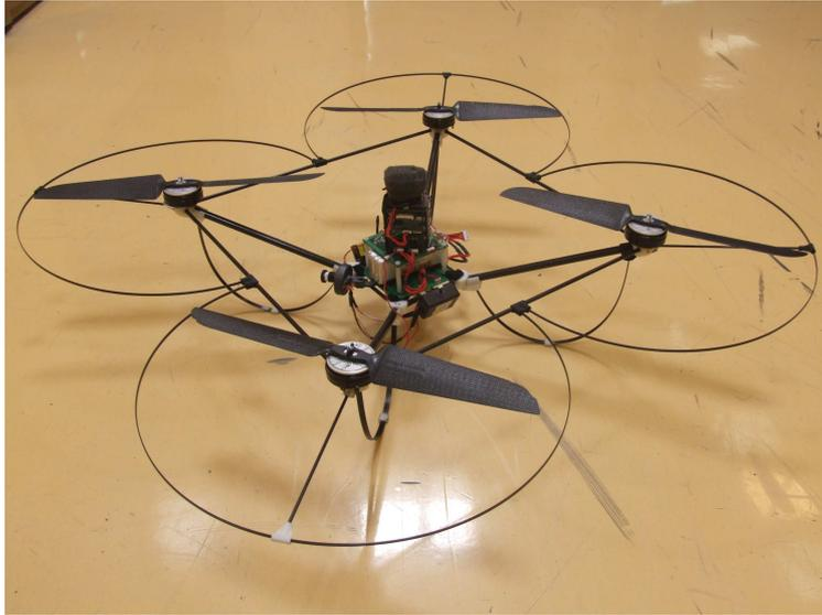
FIGURE 6.1 – Le quadrirotor développé au CEA LIST
