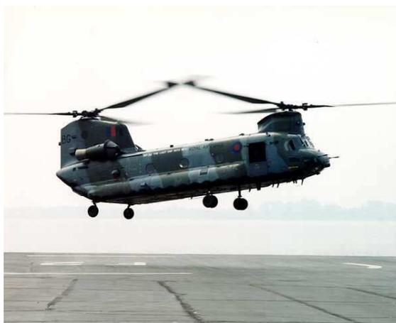
FIGURE 2.5 – Hélicoptère à rotors en tandem
