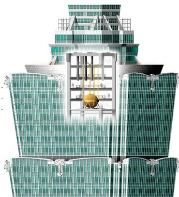
**Figure 1-26 : Confortement - Masse mobile pilotée par vérins. [Rose, 2008]**
