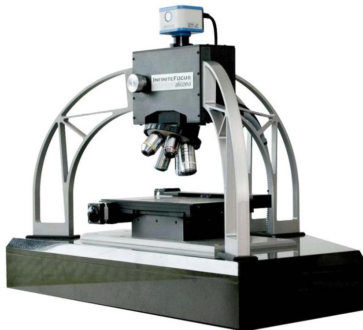
FIG. 3.6 – Appareil de mesure optique sans contact InfiniteFocus.
