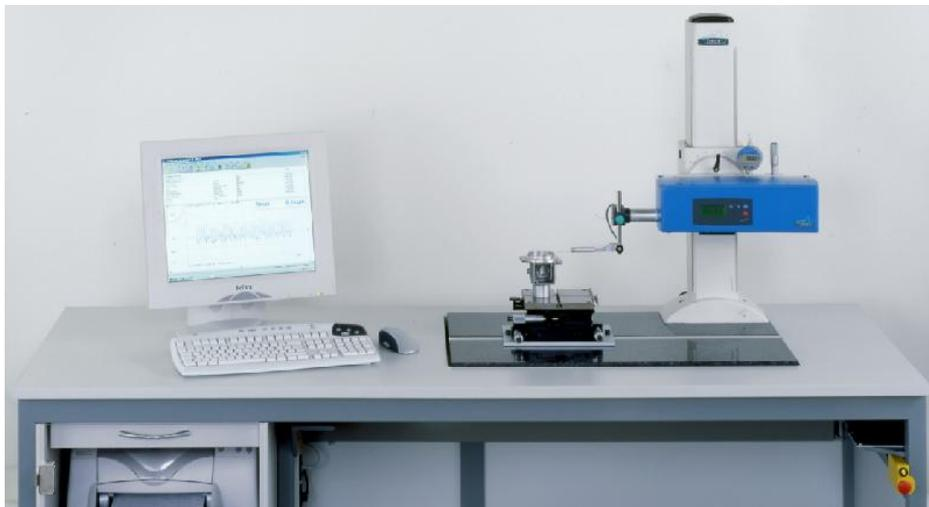
FIG. 3.8 – Photographies d'un rugosimètre à palpeur mécanique.
