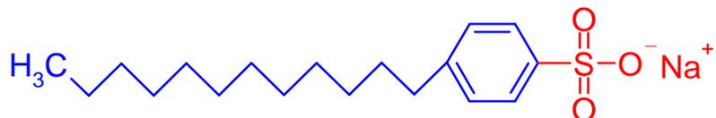
Figure II-2 : Structure moléculaire du SDBS
