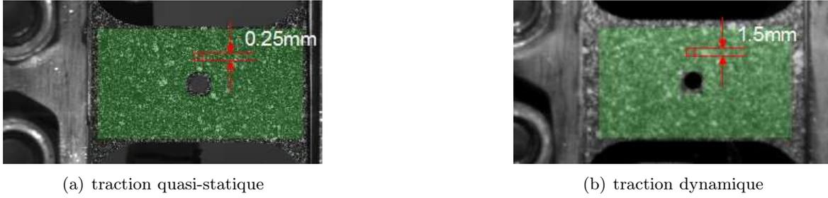
FIGURE 5.6 – Taille des cellules d'analyse pour la mesure des champs cinématiques.
