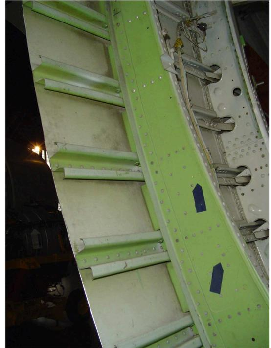
FIGURE 3.6 – Cadres et lisses du fuselage d'un Boeing 747.
