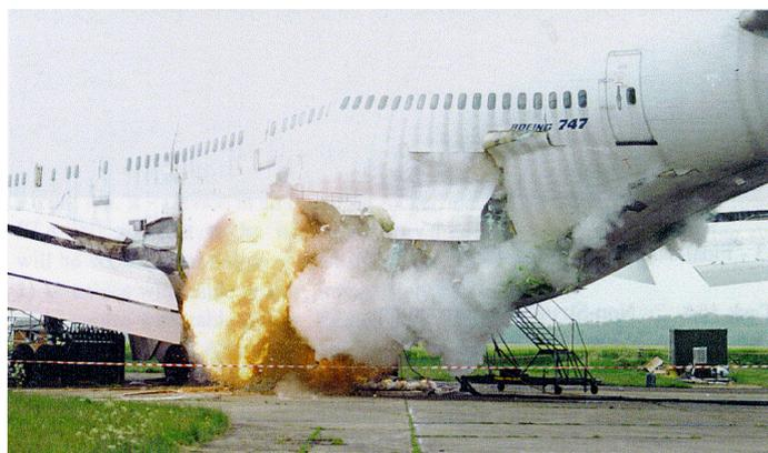
FIGURE 2.4 – Essai au sol d’une explosion dans la soute d’un boeing 747 [6].
