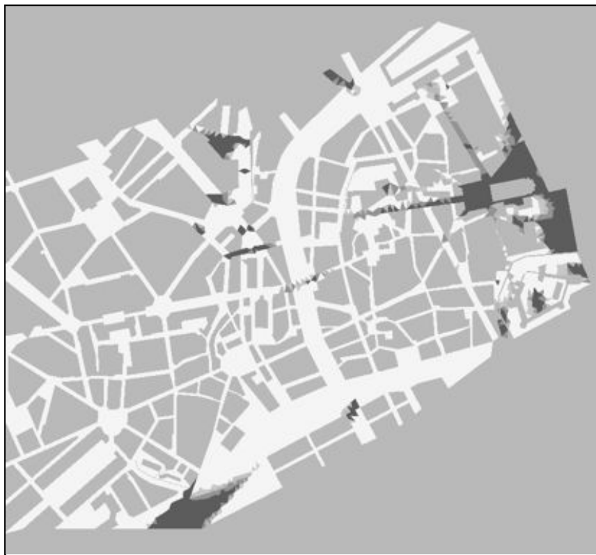
Figure 2.35. Simulation de l'accessibilité visuelle de la cathédrale dans le centre de Nantes (Document CERMA) (en noir : zones de plus forte visibilité, en blanc : zones de non-visibilité)
