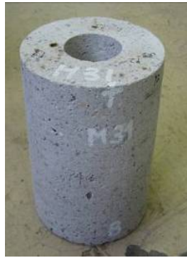
Figure III-13. Conditions et géométrie d'un écoulement radial dans un cylindre troué d'après Choinska [CHO06]
