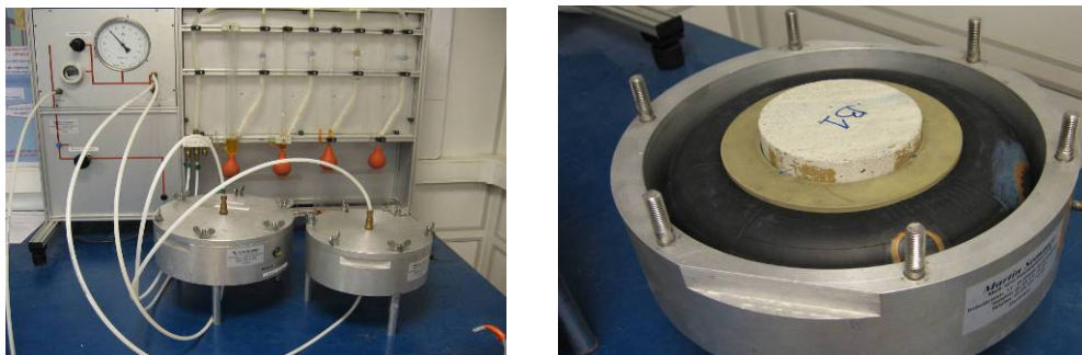
Figure II-7. Photo du dispositif expérimental a) système des tubes b) cellule confinée
