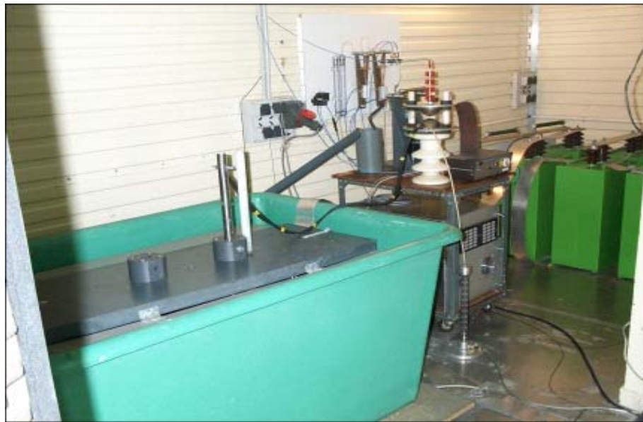
Figure II-1. Photographie du banc d'énergie associé au dispositif de fracturation [TOU 06]
