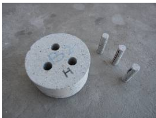
Figure II-17. Carottage des éprouvettes utilisées en microtomographie
