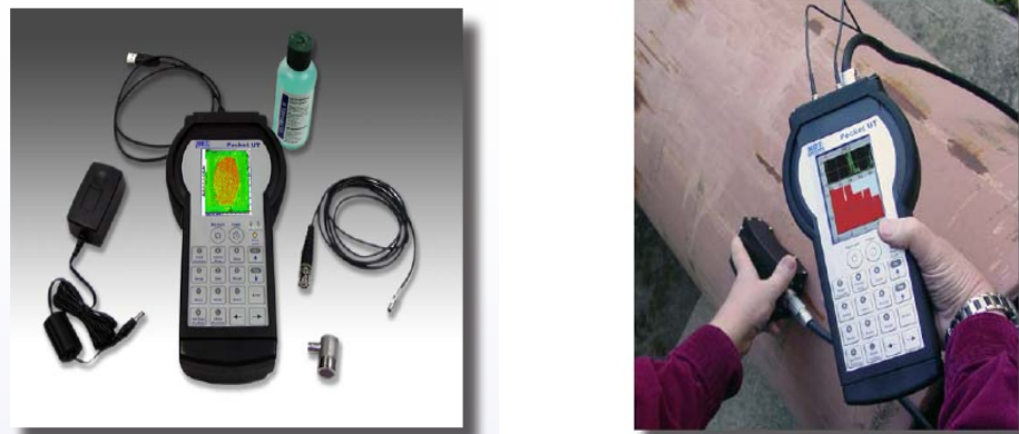
Figure III-16. Photographies du système portable ultrasonore 'Pocket UT'
