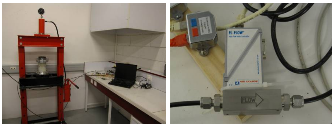
Figure III-14. Dispositifs de mesure de la perméabilité radiale
