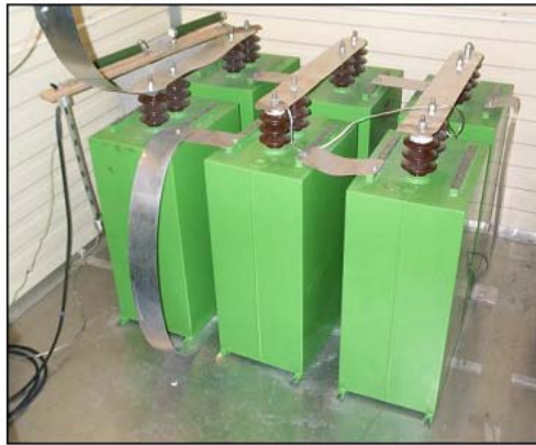
Figure II-3. a) Condensateurs de puissance b) Alimentation haute tension de chez E.T.A.T. [TOU 06]
