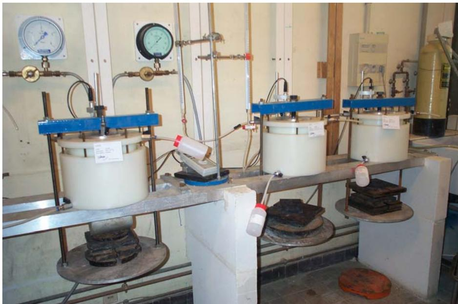
**Figure 8** - Banc d'essai d'oedoperméamètres dans le laboratoire de l'INSA-Lyon
