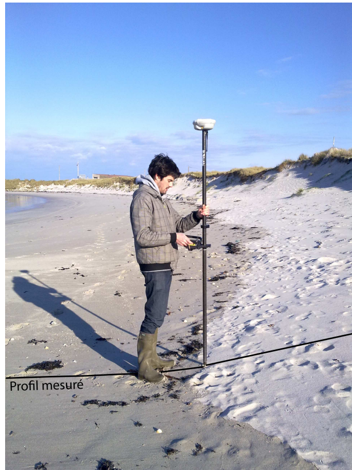
Photo 17. Mesure au DGPS de la limite atteinte par le jet de rive au niveau du profil levé sur la plage du Vougot (Guissény).
