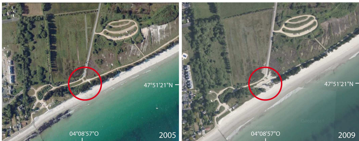
Photo 11. Vues aériennes prises avant (mars 2005) et après (2009) les ouvertures successives de la brèche de Treustel en mars 2008 et en février 2009.
