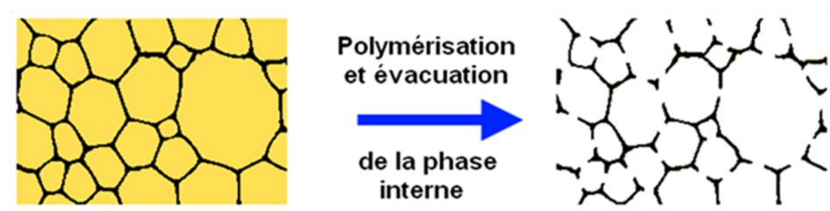
Figure 56 : Schéma représentatif de la réalisation d'une mousse de polymère à partir d'une ETC.
