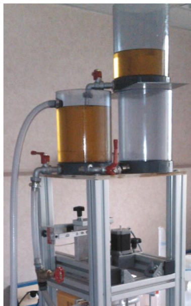
Figure 64 : Photographie du dispositif permettant une alimentation gravitaire à débit constant en huile du MDB-Cont.
