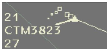
Nous avons déjà vu dans le chapitre précédent que les carrés qui forment la comète radar fusionnent pour former un seul objet (effet de continuité Gestalt [Kofka, 1935]). Ce choix de design permet aussi d'être dans une certaine mesure résistant au chevauchement ; l'utilisateur arrive à différencier les comètes même si elles se recouvrent.
