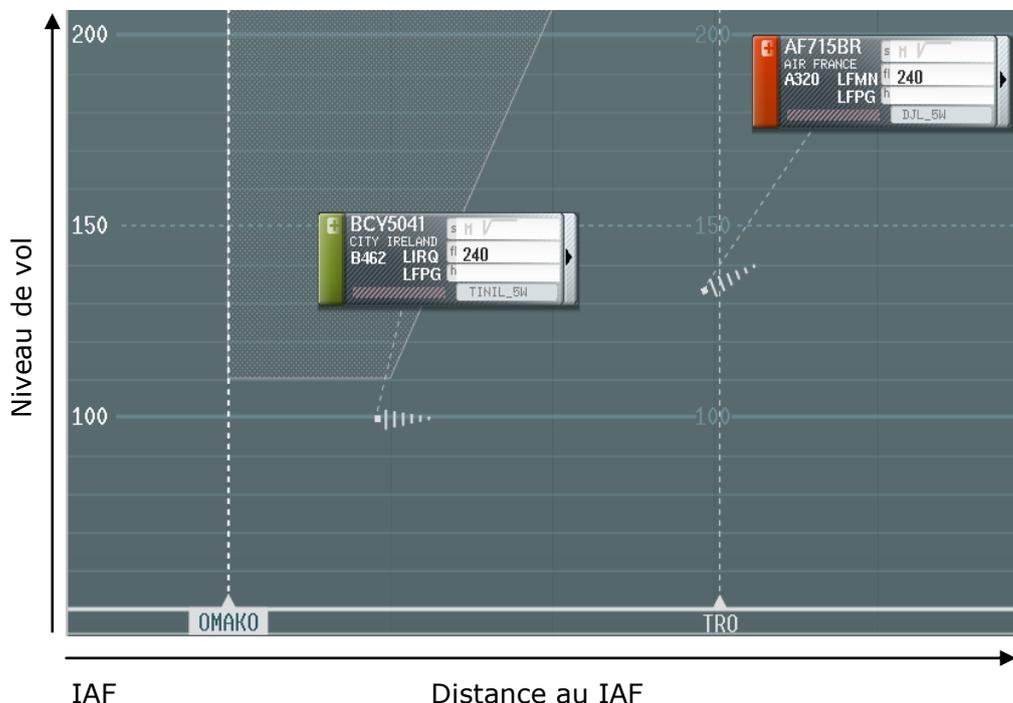
Une forme graphique (dite « comète ») représente la position de l'avion issue des données radar. La comète est placée à l'écran grâce à une fonction de projection sur l'axe IAF, balise de référence pour l'axe des X et l'altitude l'avion pour l'axe des Y. La profondeur de la comète est donnée par son occlusion par rapport aux autres comètes et une luminosité (sombre pour les comètes très distantes de la ligne de référence, clair
