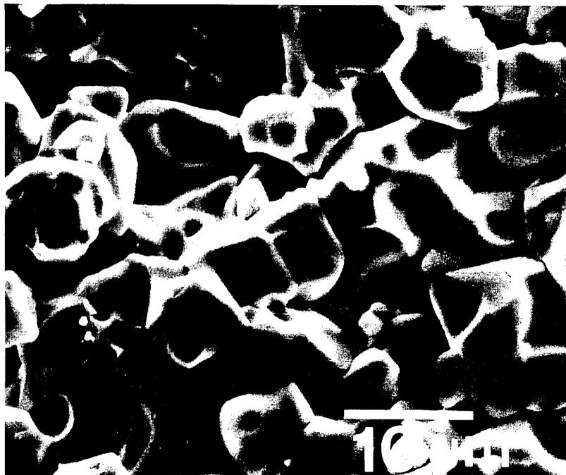
FIG. 15 - Microstructure d'une céramique de  $\text{LiTaO}_3$  préparée à partir de poudres sol-gel (M.E.B.).
