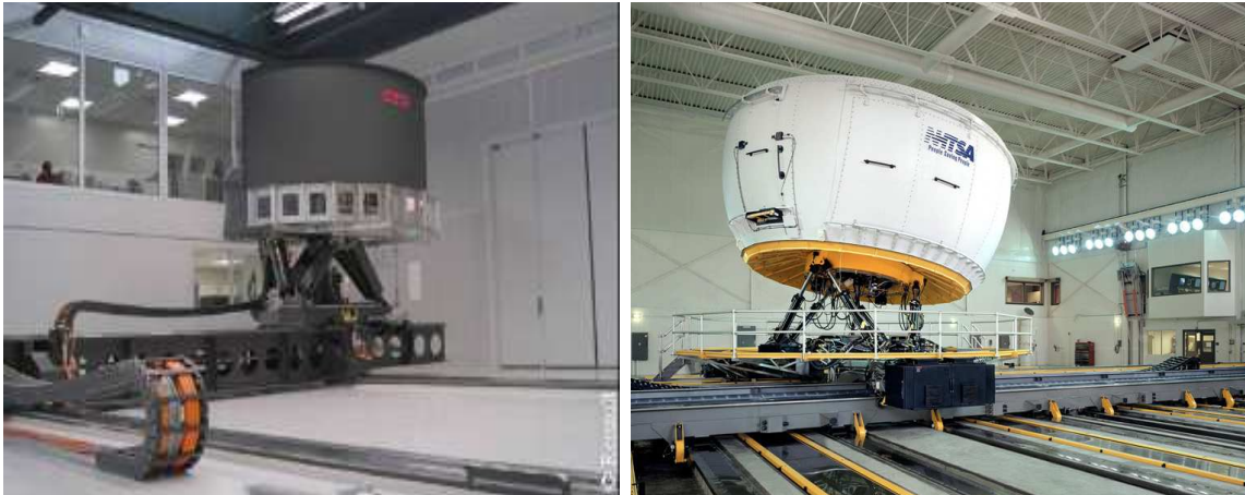
FIGURE 8.8 – Simulateurs à structure hybride : (a) Architecture hybride du simulateur ULTIMATE de Renault - France, (b) Simulateur NADS - Iowa, USA
