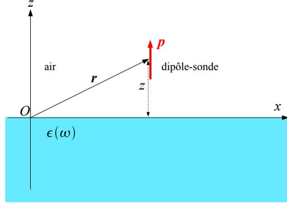
FIGURE F.3 – Milieu semi-infini constitué d'un matériau homogène de permittivité diélectrique locale  $\epsilon(\omega)$  sondé dans une expérience SNOM par un dipôle-sonde situé dans l'air à une hauteur  $z$  au-dessus de l'interface et orienté suivant l'axe  $Oz$ .
