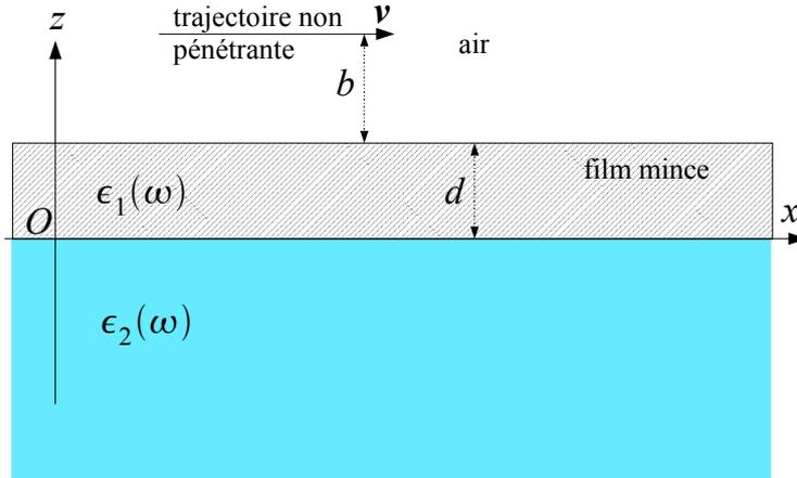
FIGURE C.10 – Milieu semi-infini de permittivité diélectrique locale  $\epsilon_2(\omega)$  recouvert d'un film mince d'épaisseur  $d$  et de permittivité  $\epsilon_1(\omega)$ . La trajectoire de l'électron est parallèle à l'interface et située à une distance  $b$  de celle-ci (trajectoire non pénétrante).
