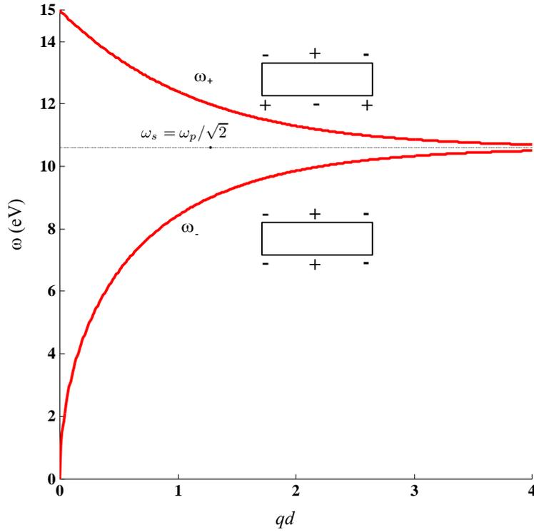
FIGURE 2.7 – Courbes de dispersion obtenues dans l'approximation non retardée ( $q \gg \omega_s/c$ ) pour un film mince d'épaisseur  $d$  décrit par un modèle de Drude non dissipatif en fonction du paramètre de couplage sans dimension  $qd$ . La branche du haut correspond aux modes antisymétriques en charge par rapport au plan horizontal du film tandis que la branche du bas correspond aux modes symétriques en charge.
