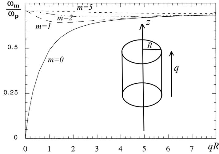
FIGURE C.7 – Courbes de dispersion des modes de surface  $m = 0, 1, 2, 5$  d'un cylindre d'aluminium de rayon  $R$  en fonction du paramètre sans dimension  $x = qR$  et dans l'approximation non retardée. Les modes  $m \neq 0$  ne dispersent quasiment pas. Adaptée de [55]. Voir aussi [125].
