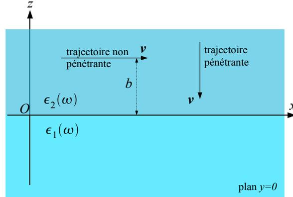
FIGURE C.2 – Interface planaire séparant deux milieux semi-infinis de permittivité diélectrique  $\epsilon_1(\omega)$  ( $z < 0$ ) et  $\epsilon_2(\omega)$  ( $z > 0$ ). La trajectoire de l'électron est soit pénétrante soit non pénétrante. Dans le cas d'une trajectoire non pénétrante, on suppose que l'électron est situé dans le milieu 2 à une distance  $b$  du milieu 1 et qu'il se propage suivant l'axe  $Ox$ .
