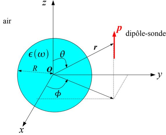
FIGURE F.4 – Particule sphérique de rayon  $R$  constituée d'un matériau de permittivité diélectrique locale  $\epsilon(\omega)$  sondée dans un expérience SNOM par un dipôle-sonde situé dans l'air à la position  $\mathbf{r} = (r, \theta, \phi)$  par rapport au centre de la sphère et orienté selon l'axe  $Oz$ .
