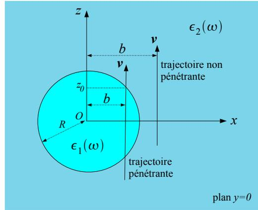
FIGURE C.5 – Particule sphérique de rayon  $R$  plongée dans un milieu homogène et infini. La trajectoire de l'électron est soit pénétrante soit non pénétrante. L'électron se déplace à une distance  $x = b$  du centre de la sphère, dans le plan  $y = 0$  et suivant l'axe  $Oz$ .
