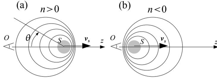
FIGURE 7.4 – Effet Doppler dans un milieu RH et LH.  $S$  est la source qui émet une onde électromagnétique sphérique et  $O$  est un observateur situé qui détecte l'onde émise par  $S$  dans la direction  $\theta = 0$ . (a) Dans un milieu conventionnel  $\Delta\omega > 0$ . (b) Effet Doppler inversé dans un milieu main-gauche ( $\Delta\omega < 0$ ).
