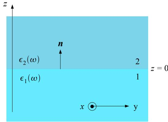
FIGURE E.1 – Une interface plane contenue dans le plan  $xOy$  séparant deux milieux semi-infinis chacun constitué d'un matériau homogène de permittivité diélectrique locale  $\epsilon_2(\omega)$  ( $z > 0$ ) et  $\epsilon_1(\omega)$  ( $z < 0$ ).
