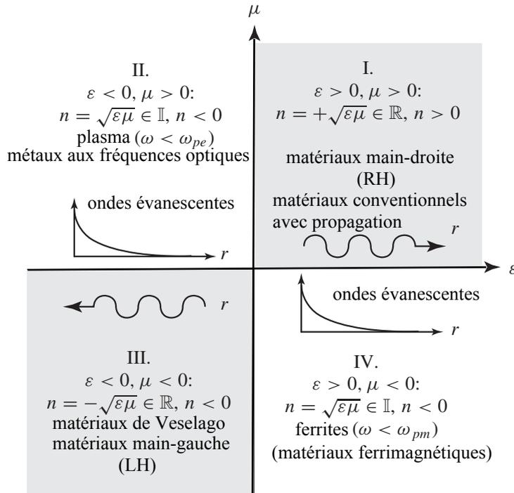
FIGURE 6.1 – Diagramme représentant les différentes régions possibles pour  $\epsilon$  et  $\mu$ . Dans chaque quadrant, on montre aussi l'allure du champ électromagnétique dans le milieu. L'énergie de l'onde se propage dans le même sens que la phase dans les milieux conventionnels (région I.) tandis qu'elle se propage dans une direction opposée à la phase de l'onde dans les milieux LH (région III.). Aucune propagation n'est possible (onde évanescente) dans les matériaux des régions II. et IV.
