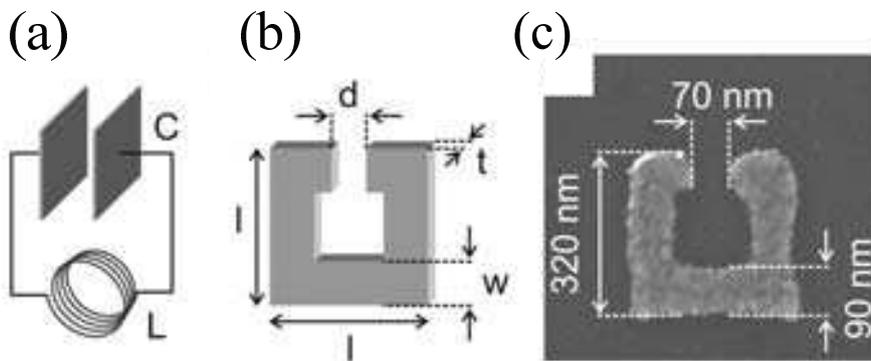
FIGURE 8.1 – Analogie qui existe entre un circuit électrique LC (a) ( $L$  : inductance de la bobine et  $C$  : capacité du condensateur) et un SRR "simple" (b). L'image (micrographie) d'un SRR typique d'or de 20 nm d'épaisseur fabriqué par lithographie électronique est montrée en (c). Adaptée de [12].
