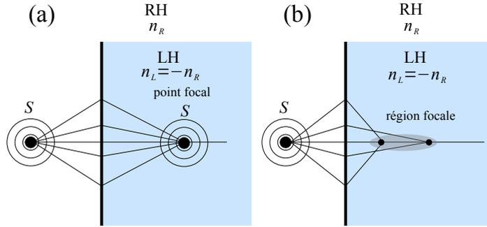
FIGURE 7.3 – Aberration sphérique dans une lentille LH. (a) Lorsque  $n_L = -n_R$ , un point focal est formé dans la lentille. (b) Lorsque  $n_L \neq -n_R$ , une aberration de sphéricité apparaît et l’image d’un point source devient une tache diffuse.
