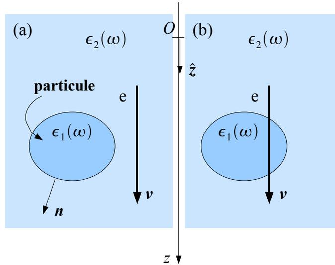
FIGURE 3.2 – On considère un électron qui se propage à la vitesse  $\mathbf{v}$  constante dans un milieu homogène et infini en présence d'une particule. (a) La trajectoire est non pénétrante. (b) La trajectoire est pénétrante.  $\hat{\mathbf{z}}$  est un vecteur directeur porté par l'axe  $Oz$  et  $\mathbf{n}$  est un vecteur normal à la surface de la particule dirigé vers l'extérieur.
