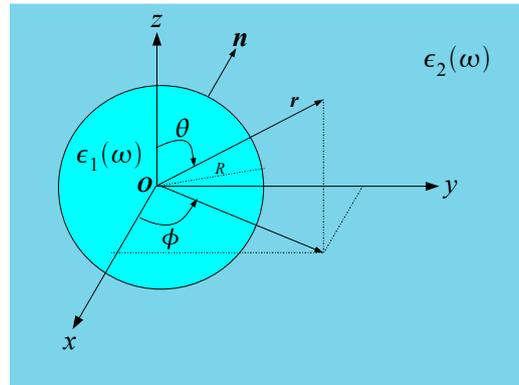
FIGURE C.4 – Particule sphérique de rayon  $R$  constituée d'un matériau homogène de permittivité diélectrique locale  $\epsilon_1(\omega)$  et plongée dans un milieu également homogène et infini de permittivité  $\epsilon_2(\omega)$ . Les variables  $(r, \theta, \phi)$  sont utilisées pour repérer un point  $\mathbf{r}$  de l'espace en coordonnées sphériques et  $\mathbf{n}$  est un vecteur unitaire normal à la surface de la sphère et orienté du milieu 1 vers le milieu 2.
