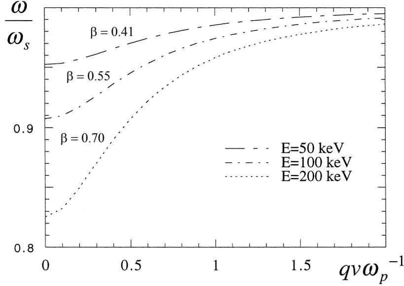
FIGURE C.3 – Courbes de dispersion des modes de surface d'un plan infini dans le régime retardé pour différentes énergies  $E$  des électrons incidents (ou différentes valeurs de  $\beta = v/c$ ) en fonction du paramètre sans dimension  $qv/\omega_p$ .
