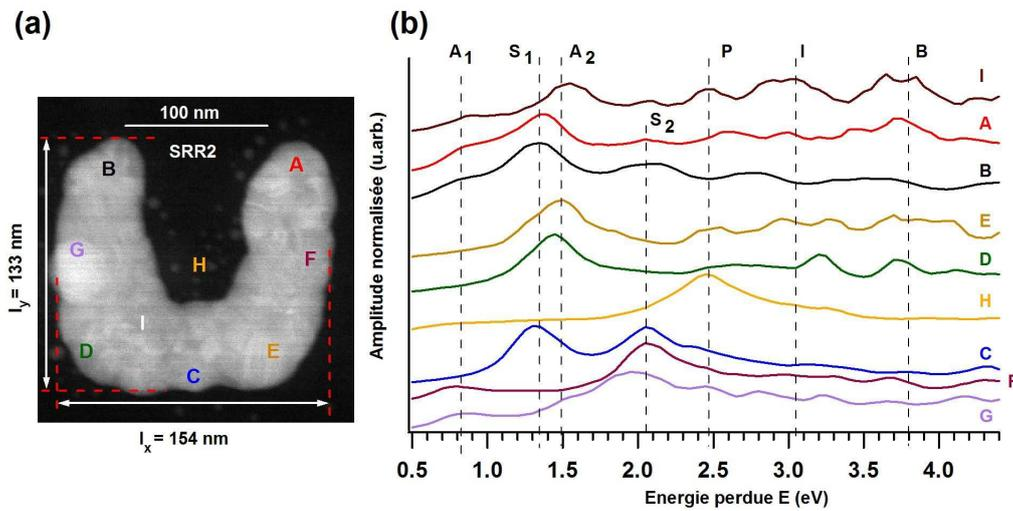
FIGURE 11.7 – (a) Image HAADF de l'échantillon SRR2. (b) Spectres EELS obtenus après déconvolution des données brutes acquises aux positions A-I indiquées en (a). Chaque spectre a été normalisé à son amplitude maximum. Les spectres ont de plus été verticalement décalés pour plus de clarté.
