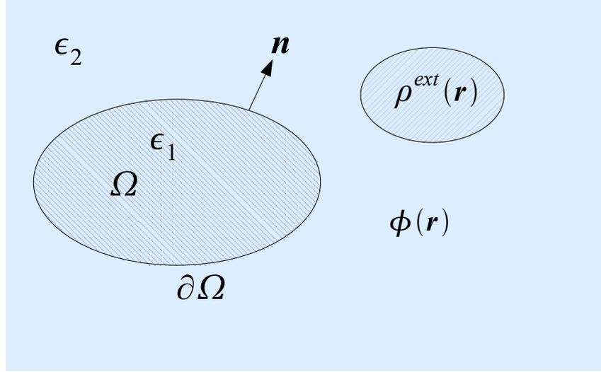
FIGURE 4.4 – On considère une particule constituée d'un matériau homogène décrit par la permittivité diélectrique  $\epsilon_1$  plongée dans milieu homogène et infini de permittivité  $\epsilon_2$ .
