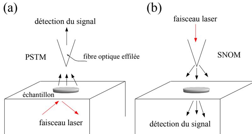
FIGURE 16.1 – Les deux modes les plus utilisés en microscopie optique de champ proche. (a) Mode détection : l'onde évanescente est détectée localement à l'aide d'une fibre optique effilée (pointe) au-dessus de la surface (PSTM). (b) Mode illumination : l'objet est illuminé avec l'onde non radiative formée à l'extrémité d'une fibre optique effilée et le signal est détecté par transmission sous la surface (SNOM). Schéma adapté de [14].
