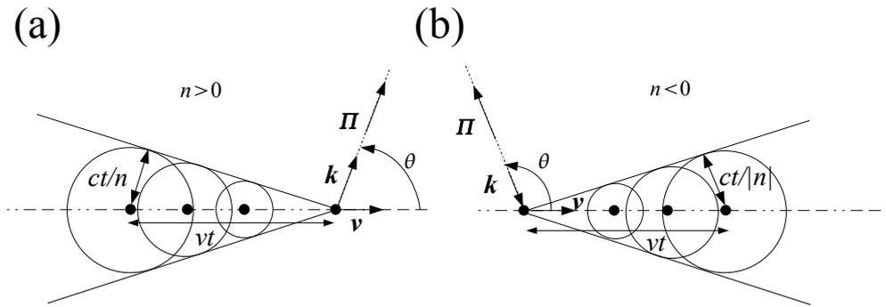
FIGURE 7.5 – Illustration de l'effet Čerenkov. (a) Milieu conventionnel ( $n > 0$ ) : le front d'onde sphérique se déplace dans le sens opposé à la source à la vitesse  $c/n$ . (b) Milieu main-gauche ( $n < 0$ ) : le front d'onde sphérique se déplace dans le même sens que la source à la vitesse  $c/|n|$ .
