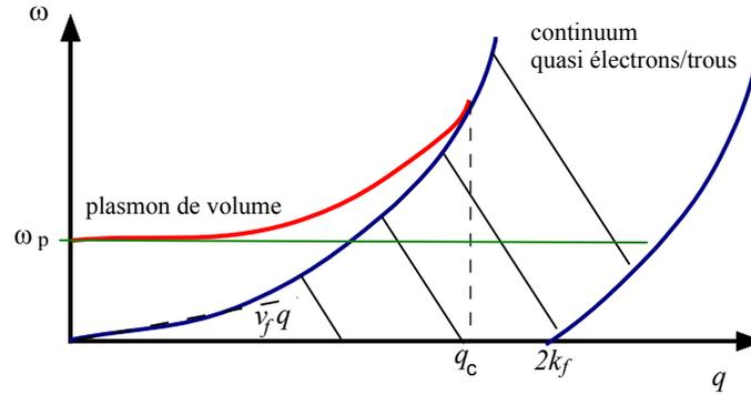
FIGURE 2.1 – *En rouge* : courbe de dispersion du plasmon de volume obtenue en utilisant un traitement quantique dans l'approximation de la phase aléatoire (RPA). Le plasmon de volume ne disperse quasiment pas tant que  $q \ll k_f$ . *En vert* : courbe de dispersion du plasmon de volume obtenue en utilisant un traitement purement classique (voir 2.11). Le plasmon de volume ne disperse jamais classiquement pour n'importe quel moment transféré.
