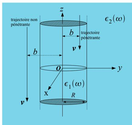
FIGURE C.8 – Particule cylindrique infinie d'axe  $Oz$  et de rayon  $R$  constituée d'un matériau homogène de permittivité diélectrique locale  $\epsilon_1(\omega)$  et plongée dans un milieu également homogène, infini et de permittivité  $\epsilon_2(\omega)$ . L'électron se propage avec une vitesse constante  $v$  parallèlement à l'axe  $Oz$  à une distance  $b$  de cet axe. La trajectoire de l'électron est soit pénétrante soit non pénétrante.
