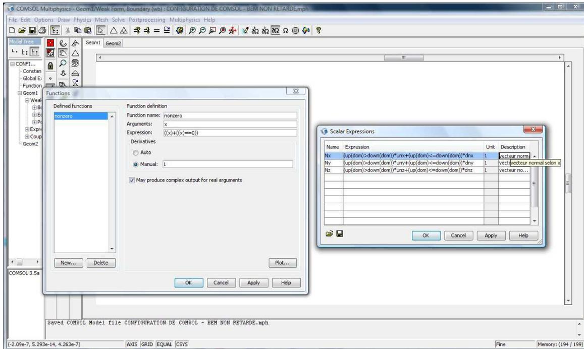
FIGURE D.3 – La fonction **nonzero** permet d'évaluer (D.1) et les autres intégrales d'intérêt partout sauf en  $\mathbf{s} = \mathbf{s}'$ . Les normales  $N_x$ ,  $N_y$  et  $N_z$  ont été créées afin de n'avoir que des normales orientées vers l'extérieur de la particule.
