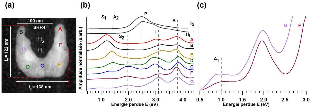
FIGURE 11.11 – (a) Image HAADF de l'échantillon SRR4. (b) Spectres EELS obtenus après déconvolution des données brutes acquises aux positions A-G, H<sub>1</sub> et H<sub>2</sub> indiquées en (a). (c) Une autre échelle a été choisie pour les spectres acquis en F et G afin d'identifier plus clairement le mode magnétique très peu intense autour de 1.01 eV. Chaque spectre a été normalisé à son amplitude maximum. Les spectres ont de plus été verticalement décalés pour plus de clarté.
