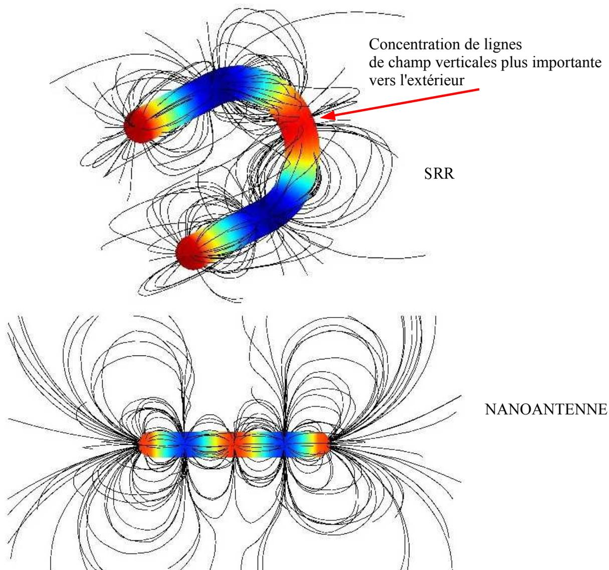
FIGURE 11.4 – *Distribution des lignes de champ électrique autour du SRR et de la nanoantenne pour le mode  $S_2$ . A cause de la forme globale en "U" du SRR, la concentration des lignes de champ verticales (suivant  $z$ , i.e., perpendiculaires au plan du SRR) est plus importante vers la partie extérieure du SRR au niveau du bras horizontal.*
