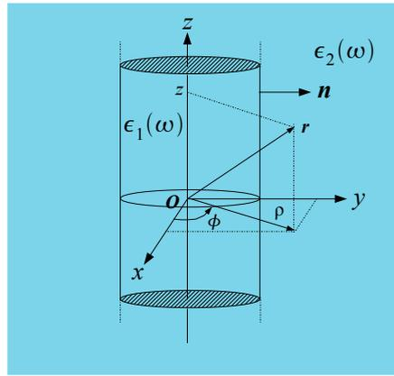
FIGURE E.4 – Un cylindre de rayon  $R$  et d'axe  $Oz$  infini constitué d'un matériau homogène de permittivité diélectrique locale  $\epsilon_1(\omega)$  et plongé dans un milieu également homogène, infini et de permittivité  $\epsilon_2(\omega)$ . Les variables  $(\rho, \phi, z)$  sont utilisées pour repérer un point  $\mathbf{r}$  de l'espace en coordonnées cylindriques.
