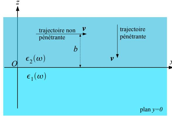
FIGURE F.1 – Interface planaire séparant deux milieux homogènes semi-infinis de permittivité diélectrique locale  $\epsilon_2(\omega)$  ( $z > 0$ ) et  $\epsilon_1(\omega)$  ( $z < 0$ ). La trajectoire de l'électron est soit pénétrante (en incidence normale) soit non pénétrante. Dans le cas où la trajectoire est non pénétrante, l'électron voyage dans le milieu 2 à une distance  $b$  fixe du milieu 1 et suivant l'axe  $Ox$ .
