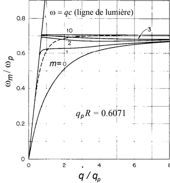
FIGURE C.9 – Courbes de dispersion retardées des modes de surface  $m = 0, 1, 2, 3, 10$  d'un cylindre de rayon  $R$  tel que  $q_p R = 0.6071$ , décrit par un modèle de Drude :  $\epsilon_1(\omega) = 1 - \omega_p^2/\omega^2$  et plongé dans le vide. La ligne en pointillés est la courbe de dispersion retardée des modes de surface à l'interface entre deux milieux semi-infinis. Adaptée de [127].
