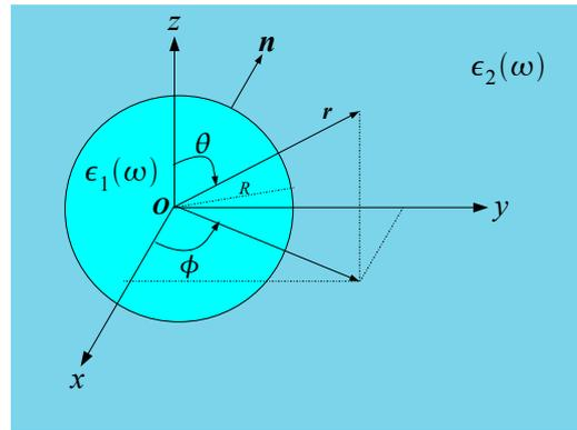
FIGURE E.2 – Une sphère de rayon  $R$  constituée d'un matériau homogène de permittivité diélectrique locale  $\epsilon_1(\omega)$  est plongée dans un milieu également homogène, infini et de permittivité  $\epsilon_2(\omega)$ . Les variables  $(r, \theta, \phi)$  sont utilisées pour repérer un point  $\mathbf{r}$  de l'espace en coordonnées sphériques.
