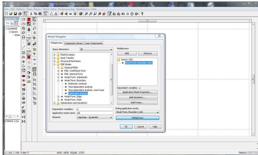
FIGURE D.1 – On choisit le mode d'application faible de COMSOL pour un problème 3D afin de résoudre n'importe quelle question intégrale aux valeurs propres : **Weak, Form Boundary (wb)/eigenvalue analysis**.
