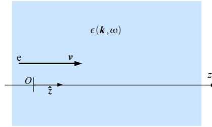
FIGURE 3.1 – Un électron de charge  $-1$  se propage à une vitesse  $\mathbf{v}$  constante dans un milieu infini décrit par la permittivité diélectrique  $\epsilon(\mathbf{k}, \omega)$ .  $\hat{\mathbf{z}}$  est un vecteur directeur porté par l'axe  $Oz$ .
