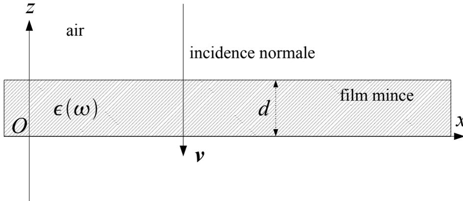
FIGURE C.11 – Film mince d'épaisseur  $d$  et de permittivité diélectrique locale  $\epsilon(\omega)$  plongé dans l'air. L'électron pénètre le film en incidence normale.
