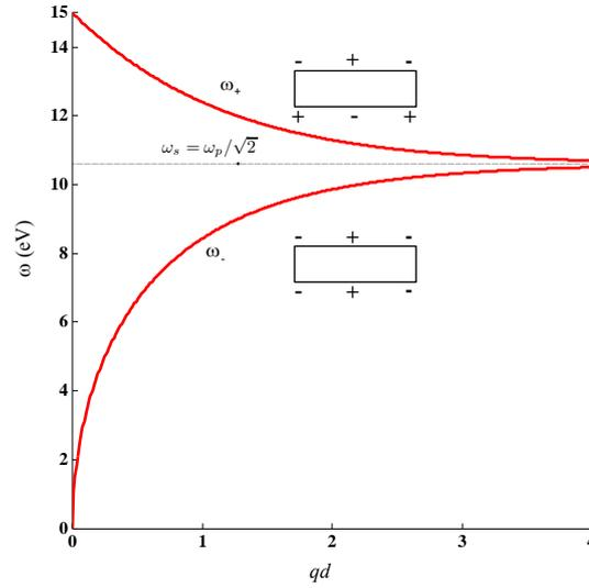
FIGURE C.12 – Courbes de dispersion obtenues dans l'approximation non retardée pour un film mince d'épaisseur  $d$  décrit par un modèle de Drude non dissipatif en fonction du paramètre de couplage sans dimension  $qd$ . La branche du haut correspond aux modes antisymétriques en charge par rapport au plan horizontal du film tandis que la branche du bas correspond aux modes symétriques en charge. La distribution de charges à la surface du film est représentée à côté de chacune des courbes.
