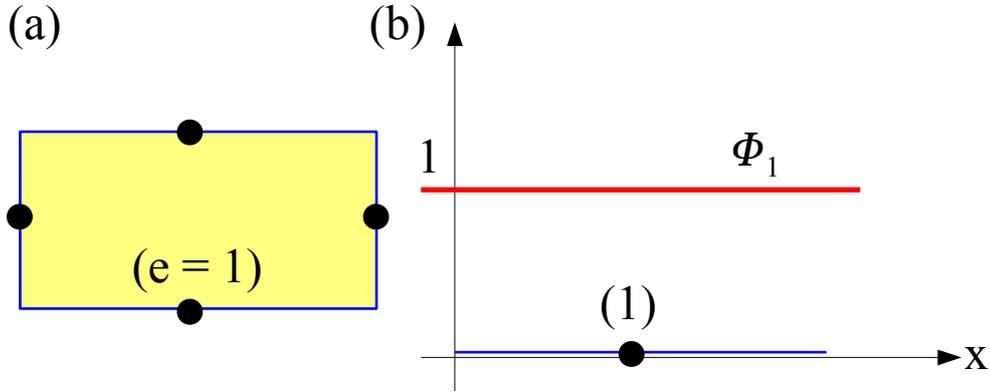
FIGURE 4.3 – Application du BEM au cas d'un rectangle. (a) Discrétisation des bords du rectangle en utilisant un élément par côté à un nœud. (b) Fonction d'interpolation constante ( $\phi_1 = 1$ ) utilisée pour interpoler la solution sur un élément de la discrétisation.
