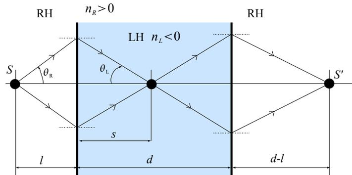
FIGURE 7.2 – Focalisation d’un faisceau lumineux par une lentille plate ayant un indice de réfraction négatif. Les deux rayons lumineux issus de  $S$  sont symétriques par rapport à l’axe de la lentille (axe optique) et forment un angle  $|\theta_R|$  par rapport à cet axe.
