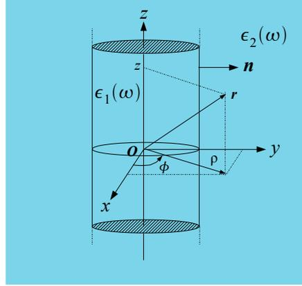
FIGURE C.6 – Particule cylindrique infinie de rayon  $R$  et d'axe  $Oz$  plongée dans un milieu homogène et infini. Les variables  $(\rho, \phi, z)$  sont utilisées pour repérer un point  $\mathbf{r}$  dans l'espace en coordonnées cylindriques et  $\mathbf{n}$  est un vecteur unitaire normal à la surface du cylindre et dirigé du milieu 1 vers le milieu 2.
