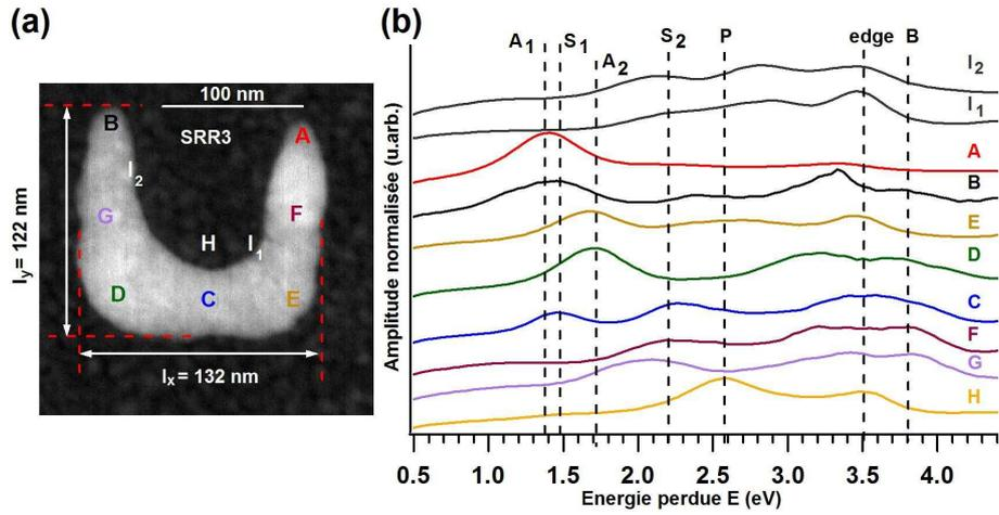
FIGURE 11.9 – (a) Image HAADF de l'échantillon SRR3. (b) Spectres EELS obtenus après déconvolution des données brutes acquises aux positions A-H, I<sub>1</sub> et I<sub>2</sub> indiquées en (a). Chaque spectre a été normalisé à son amplitude maximum. Les spectres ont de plus été verticalement décalés pour plus de clarté.
